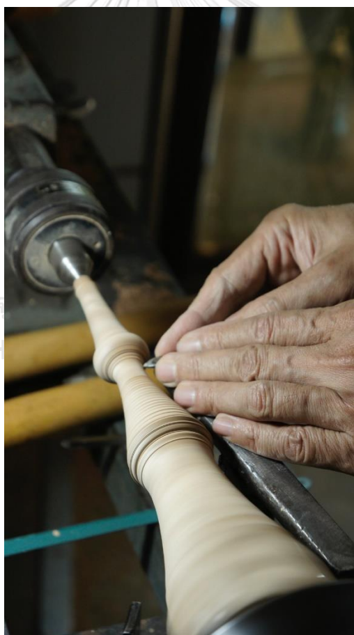
ภาพที่ 117 การกลึงทวนล่าง ที่มาภาพ : วรุตม์ ปัทมดิลก
