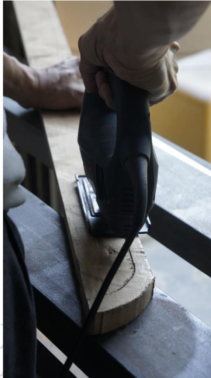
ภาพที่ 125 การเลื่อยไม้ทำคันทิ้ง ที่มาภาพ : วรุตม์ ปัทมดิลก
