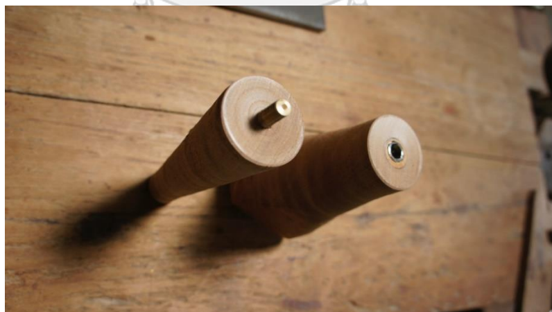
ภาพที่ 115 การเข้าเกลียวทวนล่าง ที่มาภาพ : วรุตม์ ปัทมดิลก
