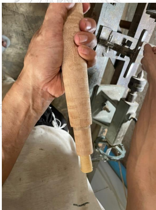
ภาพที่ 108 การกลึงเดือยทวนบนให้เข้ากับทวนกลาง ที่มาภาพ : วรุฒม์ ปัทมดิลก
