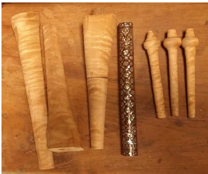
ภาพที่ 106 การเตรียมไม้ก่อนกลึง
