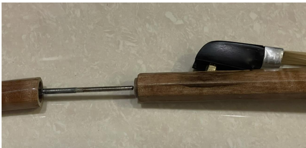
ภาพที่ 133 การใส่เกลียวตัวเร่งตั้งหย่อนของหางม้า
