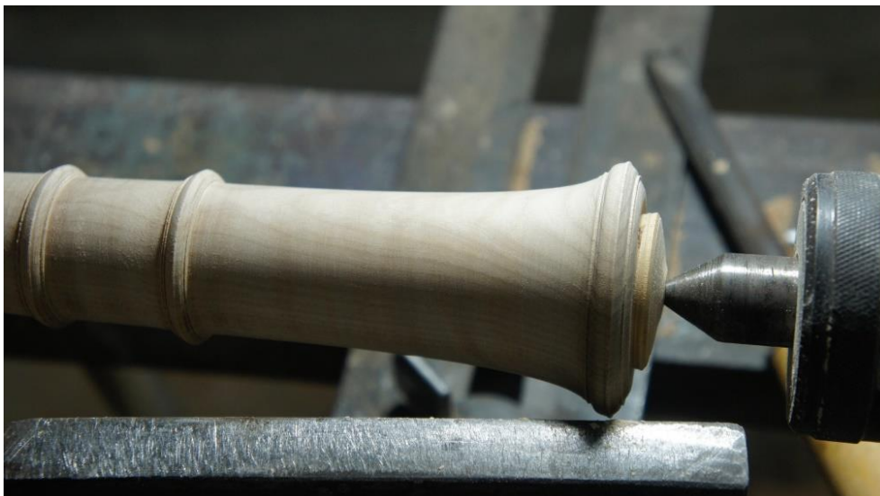
ภาพที่ 113 การกลึงรายละเอียดทวนบนเสร็จเรียบร้อย
