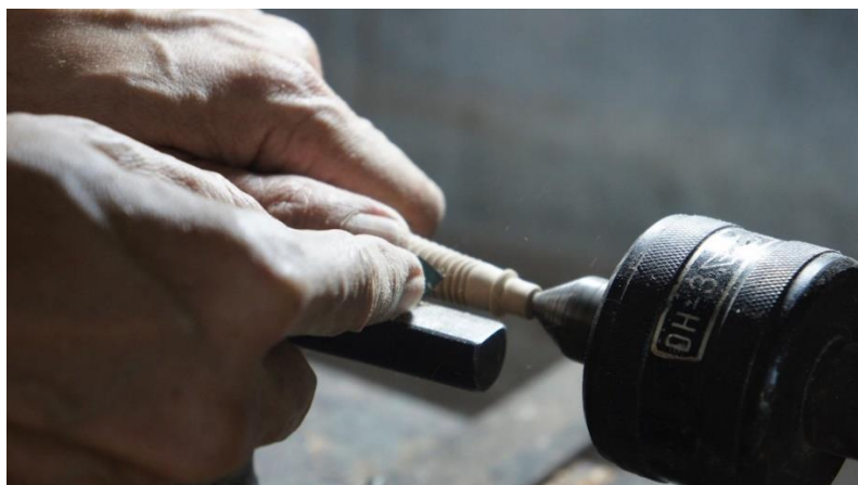
ภาพที่ 116 การกลึงเท้าขอ ที่มาภาพ : วรุตม์ ปัทมดิลก
