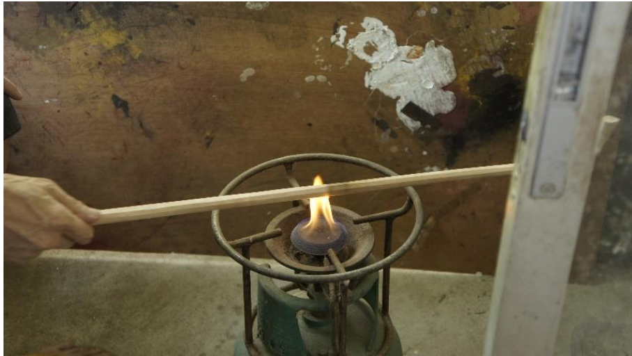
ภาพที่ 129 การใช้ความร้อนตัดคันทัก
