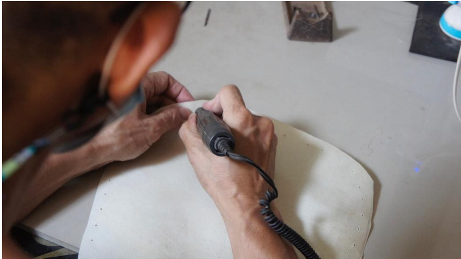
ภาพที่ 97 การเจาะรูด้วยสว่านเพื่อร้อยเหล็กหมาด ที่มาภาพ : วรุตม์ ปัทมดิลก
