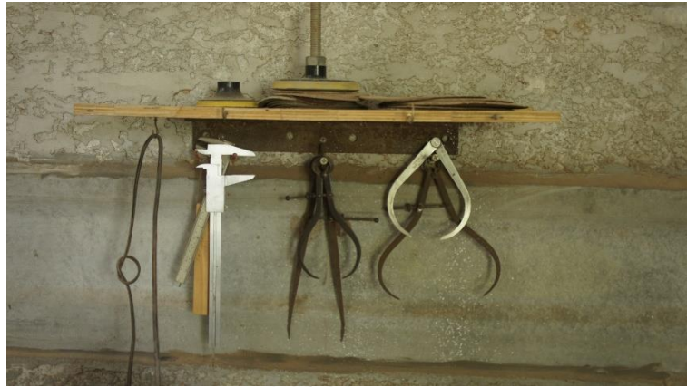
ภาพที่ 78 ตัววัดนอก ตัววัดใน ที่มาภาพ : วรุฒม์ ปัทมดิลก
