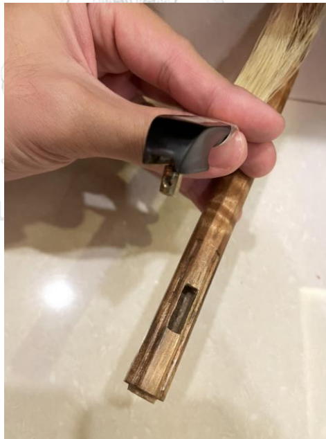
ภาพที่ 132 เกลียวตัวเร่งตั้งหย่อนของหางม้า ที่มาภาพ : วรุฒม์ ปัทมดิลก
