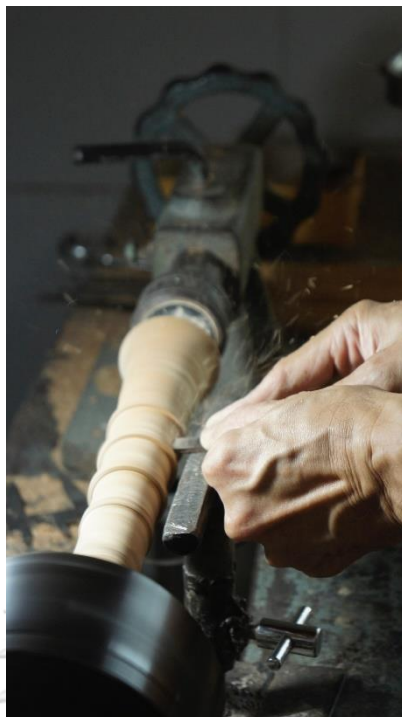
ภาพที่ 119 การกลึงเพื่อเจาะรูลูกบิด ที่มาภาพ : วรุฒม์ ปัทมดิลก
