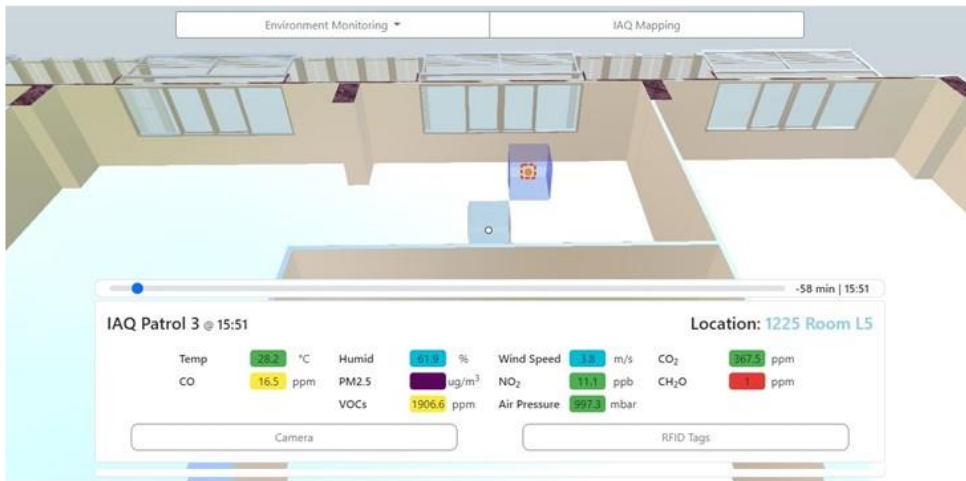
ภาพที่ 24 แสดงการทำงานของอุปกรณ์เคลื่อนที่อัจฉริยะที่เพื่อตรวจคุณภาพอากาศร่วมโปรแกรมประยุกต์อาคารคู่แฝดดิจิทัล ที่มา: (เทิดศักดิ์ เตชะกิจขจรและกวีไกร ศรีหิรัญ 2564ก)
