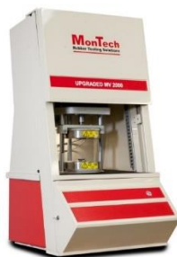
รูปที่ 7 เครื่องทดสอบความหนืด (Mooney viscometer)
