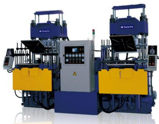
รูปที่ 3 เครื่องอัดขึ้นรูป (Compression molding)
