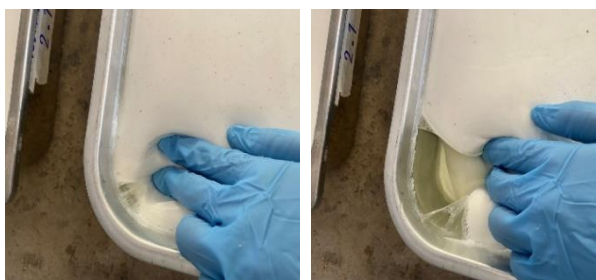
รูปที่ 12 ลักษณะของก้อนยางที่ผ่านการจับตัวด้วยกรดอย่างสมบูรณ์ (ภาวะที่ใช้ในการจับตัวน้ำยาง: ปริมาณเนื้อยางแห้ง 20% และกรดฟอร์มิกที่ความเข้มข้น 4%)
