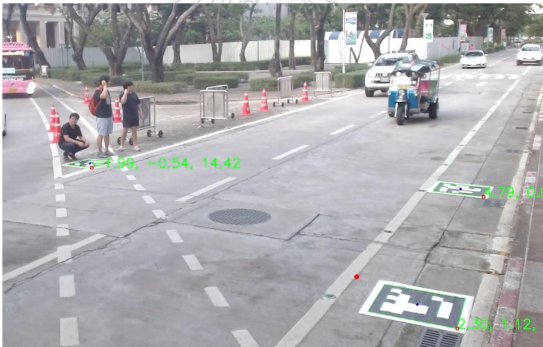
รูปที่ 54 การทดสอบสร้างระนาบจาก ArUco Marker 3 ชนิดบนพื้นที่ทดสอบจริง การหาระยะเริ่มต้นของ Merging Point เทียบกับกล้อง
