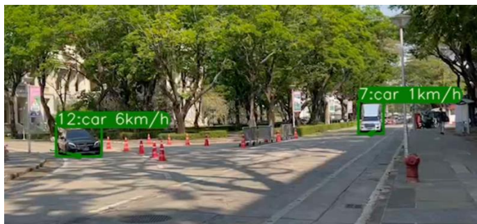
รูปที่ 75 ตัวอย่างผลลัพธ์จากกระบวนการติดตามวัตถุด้วย DeepSORT Tracking Algorithm
