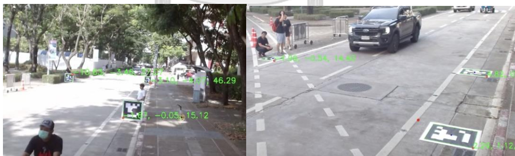
รูปที่ 76 การทดลองวัดค่าพิกัดของ ArUco Marker . ในบริเวณพื้นที่จริง
