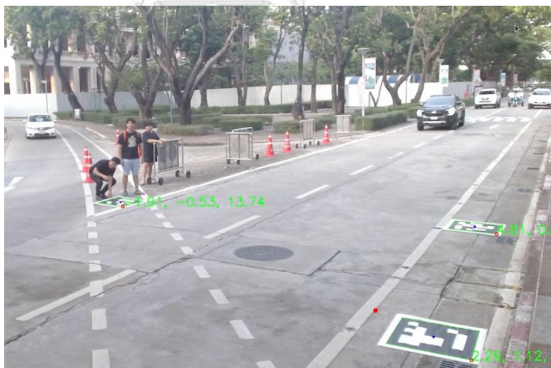
รูปที่ 77 การติดตั้ง ArUco Marker เพื่อทำการคำนวณสมการระนาบในบริเวณพื้นที่จริง
