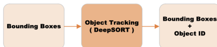
รูปที่ 37 แผนผังแสดงข้อมูลที่นำเข้าสู่ระบบตรวจจับเข้าสู่ระบบติดตามวัตถุ
