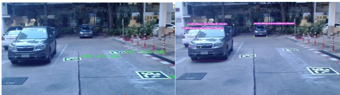
รูปที่ 81 ผลการวัดระยะของยานยนต์จากการตรวจจับด้วยภาพโดยสร้างระนาบจากการติดตั้งแผ่น ArUco Marker ในแนวราบ
