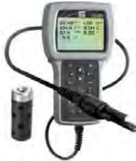
เครื่องวัดปัจจัยทางเคมีในมวลน้ำ YSI multiprobe
