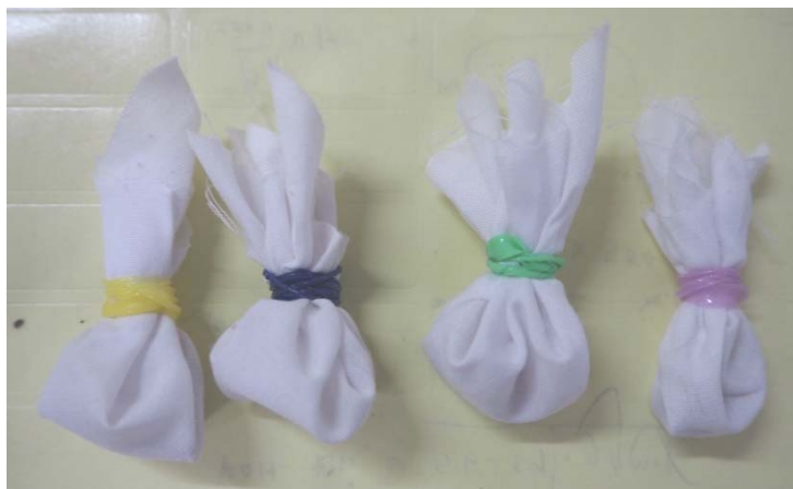
รูปที่ 16 ตัวอย่างเอมีตอกซิมพอลิเมอร์เจลที่ห่อด้วยผ้าขาวบาง
