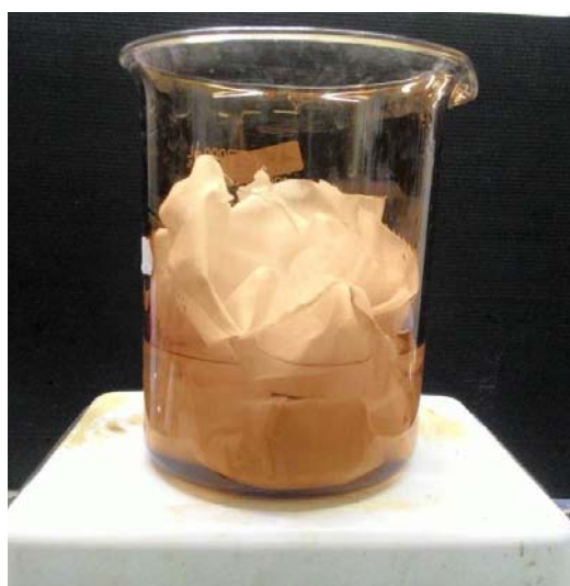
รูปที่ 14 ขั้นตอนการแช่เอมีตอกซิมพอลิเมอร์เจลในกรดไฮโดรคลอริก
