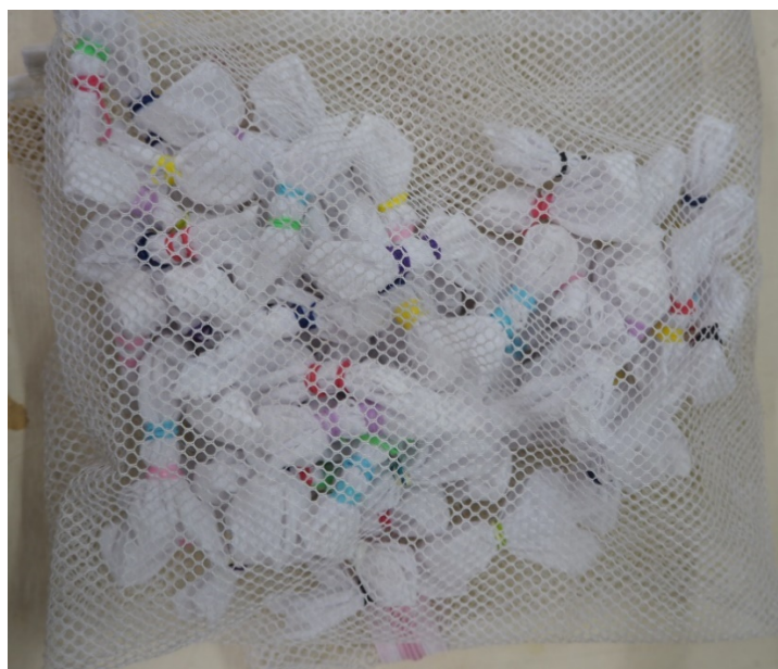
รูปที่ 17 ตัวอย่างทั้งหมดที่เตรียมใส่ในถุงตาข่ายเพื่อเตรียมลงจุ่มแช่ในถังบรรจุน้ำทะเล
