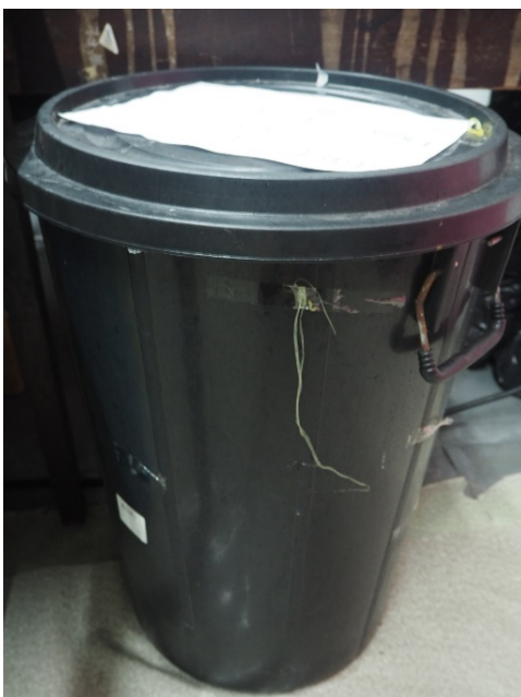
รูปที่ 18 ถังบรรจุน้ำทะเลที่ใช้ในการจุ่มแช่ตัวดูดซับยูเรเนียมในห้องปฏิบัติการวิจัย
