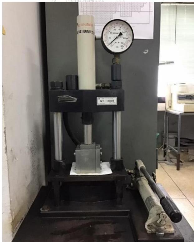
รูปที่ 3.3 เครื่องอัดขึ้นรูปแบบทิศทางเดียว
