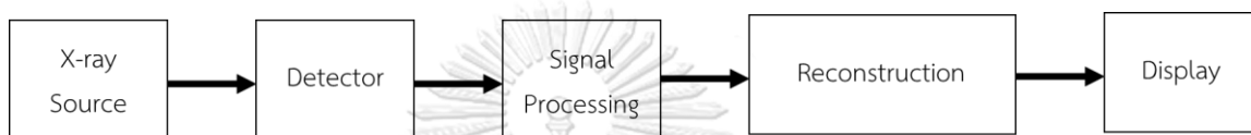
รูปที่ 30 กระบวนการทำงานของเครื่องเอกซเรย์คอมพิวเตอร์
