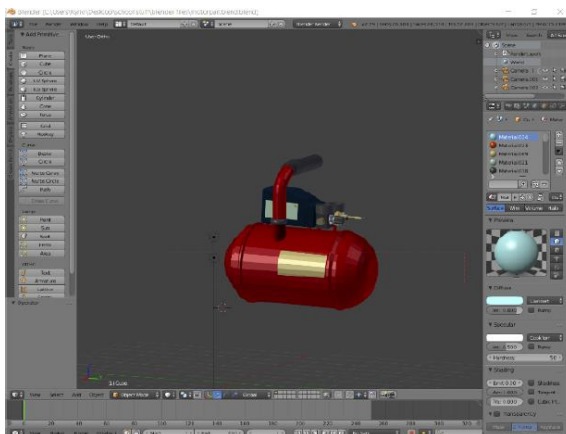
รูปที่ 5 การแบบจำลองส่วนประกอบนิวเมติก (คอมเพรสเซอร์) สามมิติด้วยโปรแกรมเบลนเดอร์ [6]
