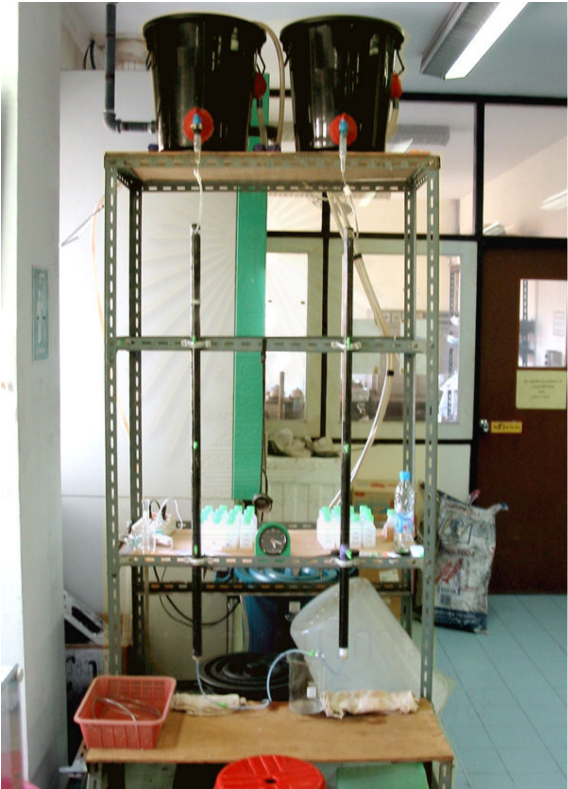
รูปที่ 3.8 ระบบถังดูดติดผิวน้ำแบบแท่งที่ใช้ในการทดลอง
