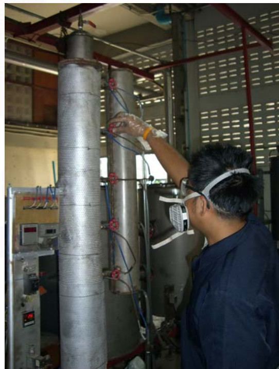
รูปที่ 3-7 การปรับตั้งอุณหภูมิของเครื่องกลั่นและการควบคุมการกลั่นที่หอกลั่นระดับต่าง ๆ
