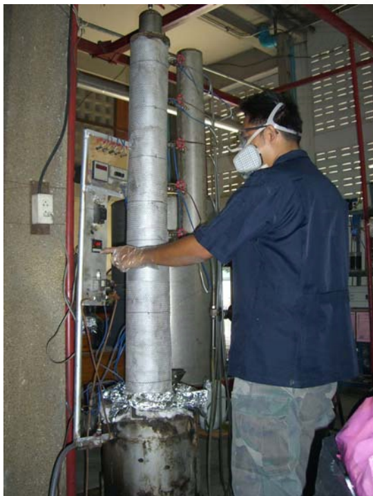
รูปที่ 3-7 การปรับตั้งอุณหภูมิของเครื่องกลั่นและการควบคุมการกลั่นที่หอกลั่นระดับต่าง ๆ
