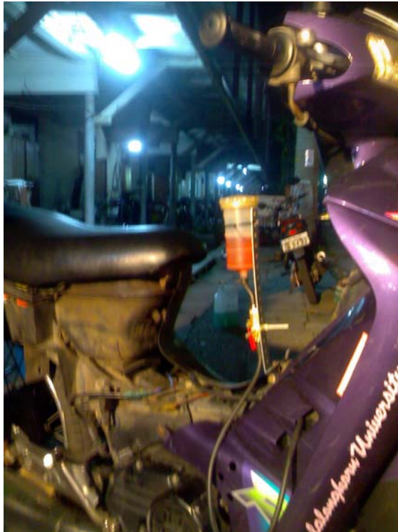
รูปที่ 3-10 การติดตั้งระบบจ่ายน้ำมันแก๊สโซลีนสังเคราะห์เพื่อวิเคราะห์อัตราการสิ้นเปลืองโดยการขับขี่จริง
