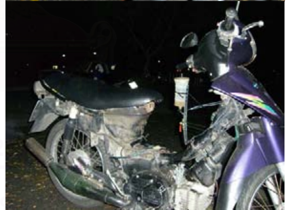
รูปที่ 3-10 การติดตั้งระบบจ่ายน้ำมันแก๊สโซลีนสังเคราะห์เพื่อวิเคราะห์อัตราการสิ้นเปลืองโดยการขับขี่จริง
