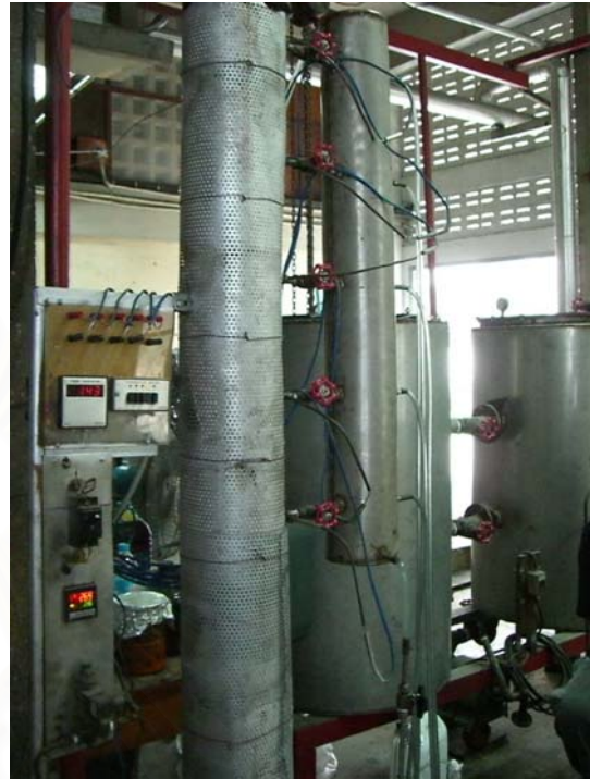
รูปที่ 3-6 เครื่องกลั่นขนาดกำลังการกลั่น 1 ลิตรต่อชั่วโมง
