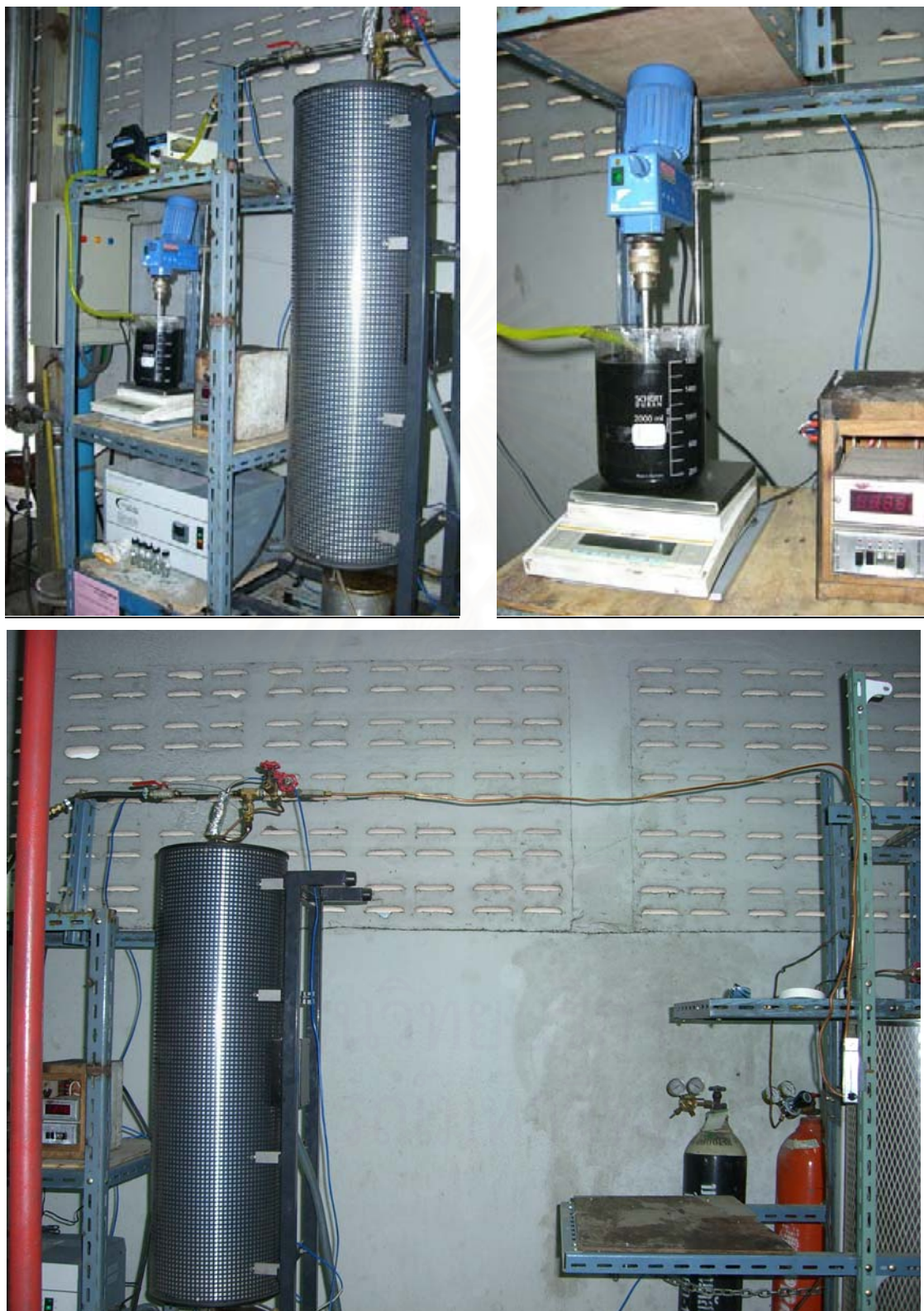
รูปที่ 3-3 การติดตั้งการทดลองเครื่องปฏิกรณ์แบบต่อเนื่องในระบบที่ใช้แก๊สไฮโดรเจน
