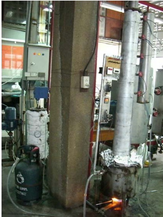
รูปที่ 3-6 เครื่องกลั่นขนาดกำลังการกลั่น 1 ลิตรต่อชั่วโมง
