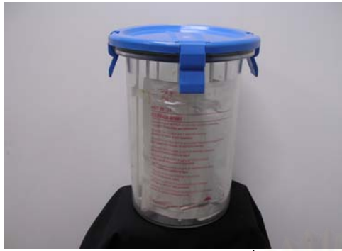
ภาพที่ 3 (ก) Anaerobic jar ที่ใส่ GENbox anaer (ข) ขวดแก้วเลี้ยงเชื้อ จุกยาง และคลิมเปอร์ (ใช้ปิดฝาโลหะ)
