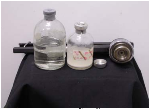
ภาพที่ 3 (ก) Anaerobic jar ที่ใส่ GENbox anaer (ข) ขวดแก้วเลี้ยงเชื้อ จุกยาง และคลิมเปอร์ (ใช้ปิดฝาโลหะ)
