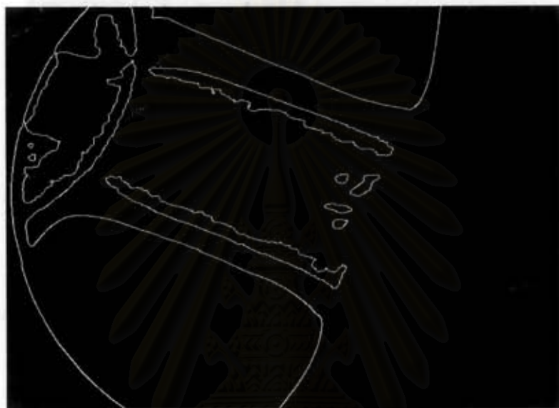
รูปที่ 4.14 ภาพแสดงผลการหาขอบภาพจากข้อมูลภาพในรูปที่ 4.12
