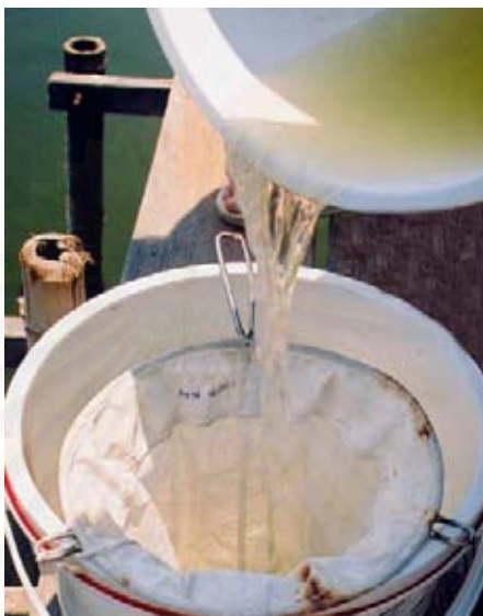
ภาพที่ ค1 ตัวอย่างน้ำ 20 ลิตร กรองผ่านผ้ากรอง 200 ไมโครเมตร
