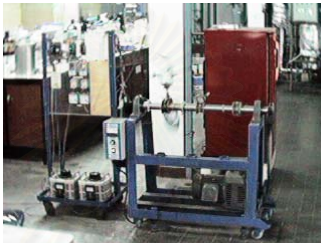
รูปที่ 3.2 ชุดทดลองประกอบด้วยชุดอุปกรณ์ควบคุมอุณหภูมิแบบดิจิทัล หม้อแปลงไฟฟ้า และเครื่องเขย่า
