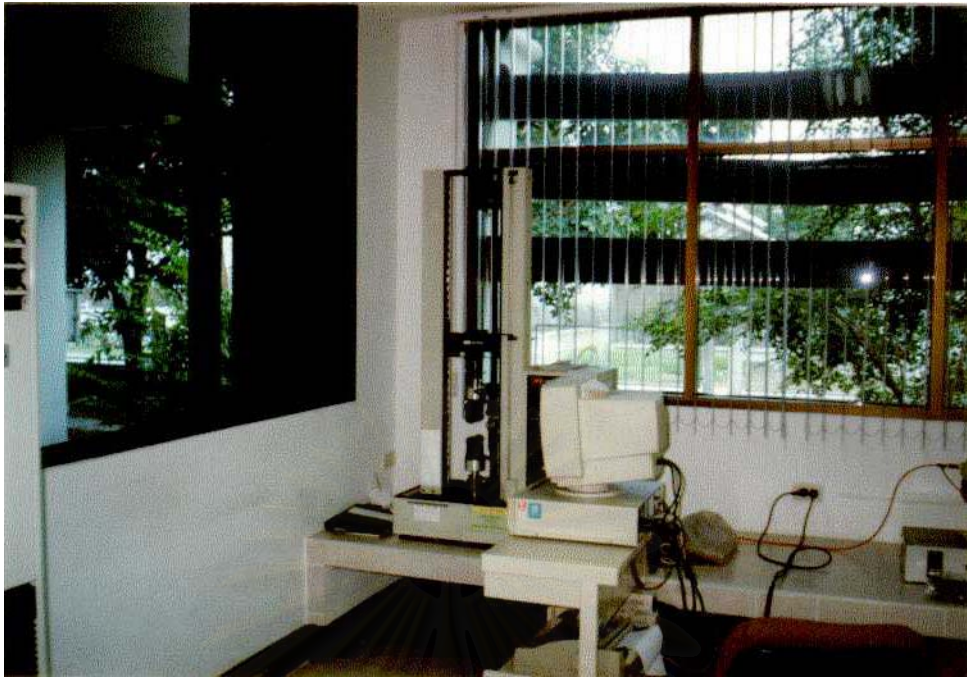
รูปที่ 3.10 เครื่องทดสอบแรงดึง (Tensile Tester) แบบ IOII/Series IX ของ Instron
