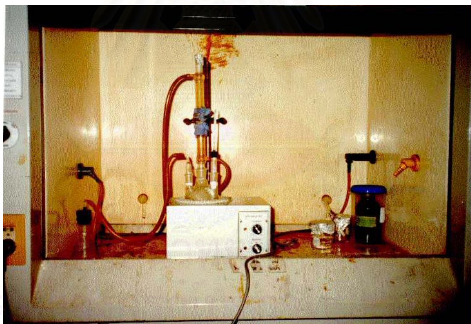
รูปที่ 3.7 อุปกรณ์ที่ใช้ในการเตรียมผงเส้นใยเซลลูโลส
