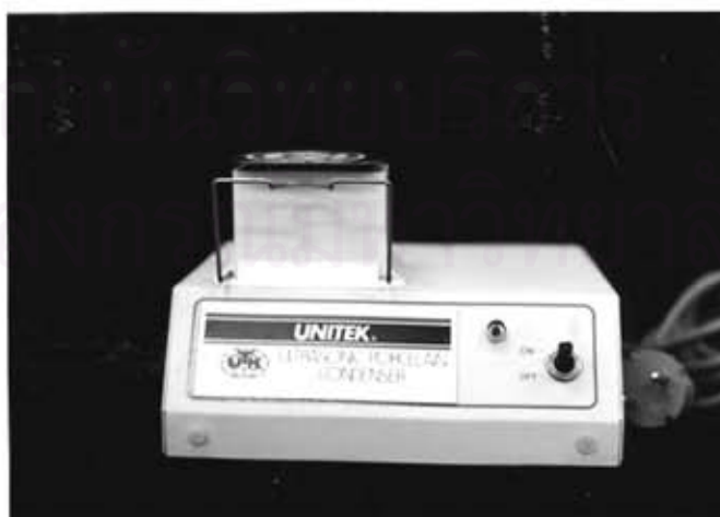
รูปที่ 3-3 แสดงเครื่องเซรามิกคอนเดนเซอร์
