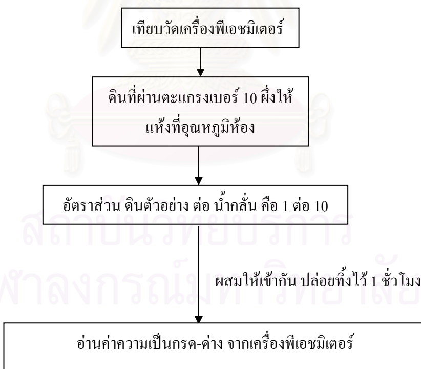
รูปที่ ก-3 การดำเนินการตามวิธีการของ ASTM D 4972-95a Standard Test Method for pH of Soil
