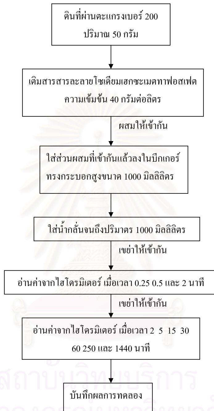
รูปที่ ก-2 การดำเนินการตามวิธีการของ ASTM D 422-63
