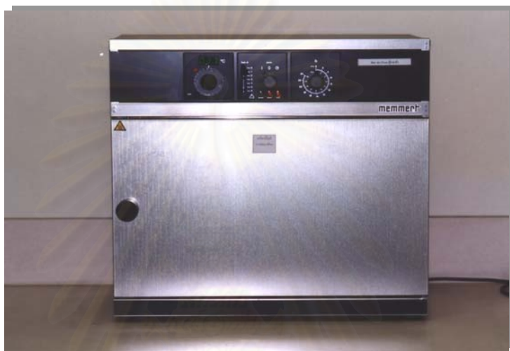
ภาพที่ 3 ตู้ควบคุมอุณหภูมิ
