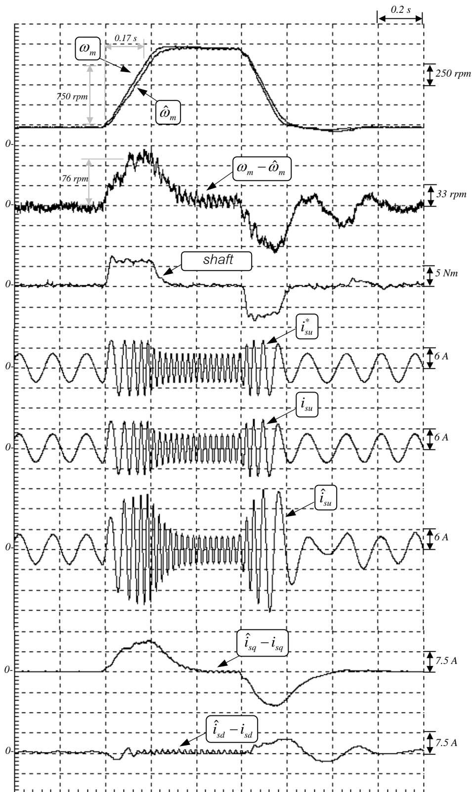
รูปที่ 6.6 ผลการทดลองการเร่งลดความเร็วเพื่อดูผลตอบสนองแบบแรมปีของระบบประมาณค่าความเร็ว ที่ K_I = 40 , K_P = 2
