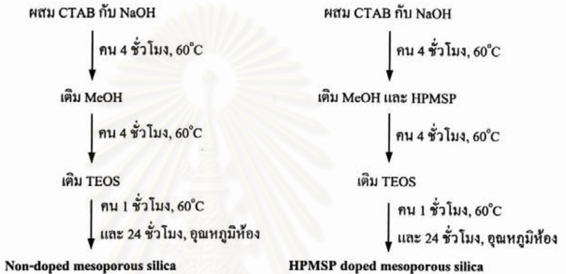
รูปที่ 2.1 แผนผังแสดงการสังเคราะห์เมโซพอร์ซิลิกาทั้ง 2 ชนิด
