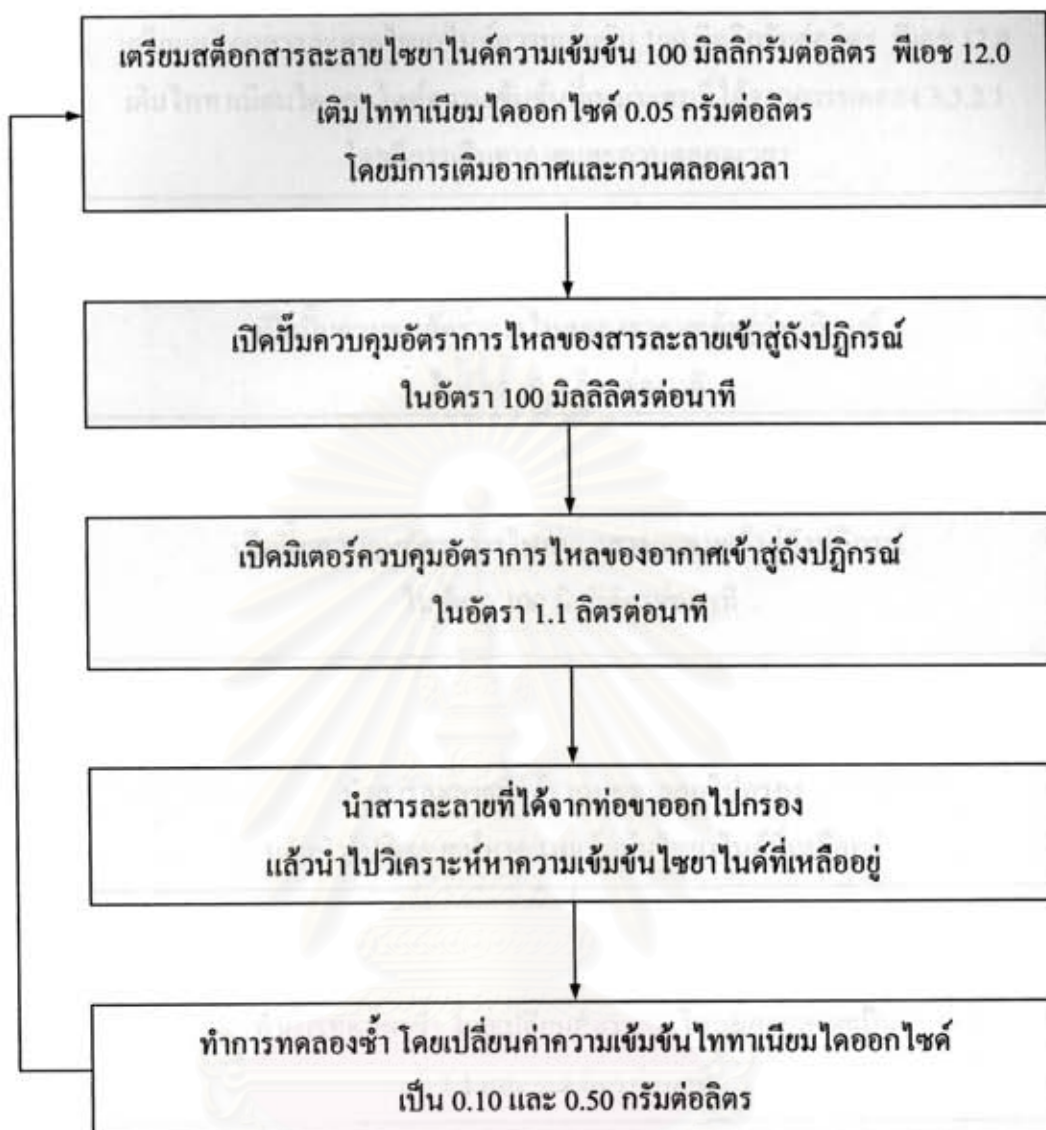
รูปที่ 3.5 ผังการทดลองการกำจัดไซยาไนด์ในน้ำเสียสังเคราะห์ด้วยการออกซิเดชันด้วยรังสี อัลตราไวโอเล็ตร่วมกับไททานเนียมไดออกไซด์ในถังปฏิกรณ์แบบไหลต่อเนื่อง เพื่อศึกษาผลของความเข้มข้นของไททานเนียมไดออกไซด์
