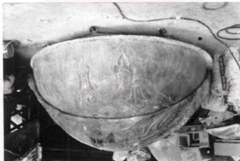
ถอดพิมพ์ชั้น B เตรียมตกแต่งและปิดทอง
