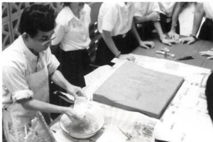
ผสมสีฝุ่นกับปูนพลาสติกอร์เพื่อทำผิวแม่พิมพ์
