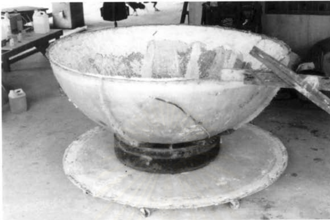
ประกอบชิ้นส่วนพิมพ์ประกอบรอบพิมพ์ซิลิโคน
