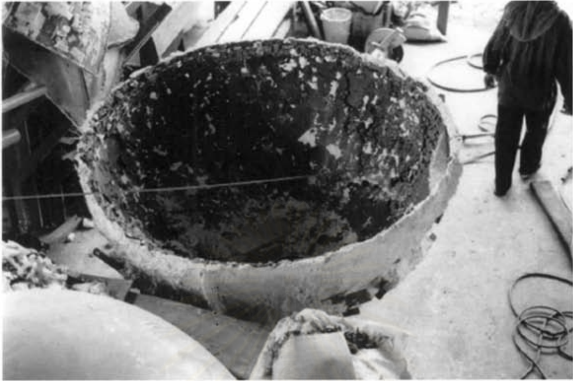
ทลายแม่พิมพ์เพื่อแกะดินน้ำมันออก
