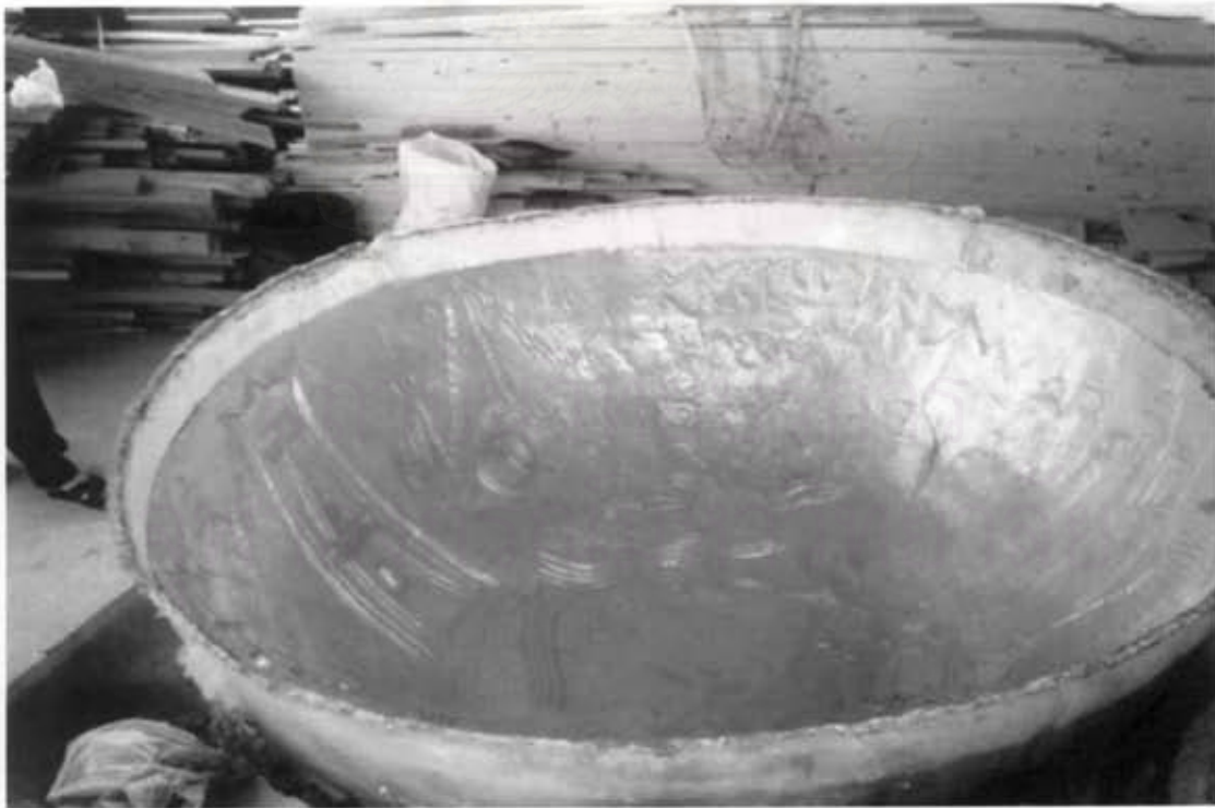
ทำความสะอาดพิมพ์แล้วปิดทองภายใน
