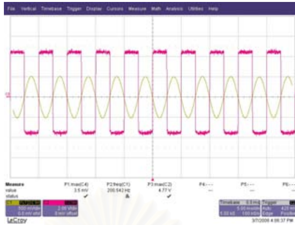
รูปที่ ก.6 แสดงสัญญาณอินพุตขนาด 500 mV และเอาต์พุตเมื่อมีแกนเวลาเป็น 5 ms/Div
