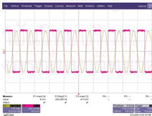
รูปที่ ก.8 แสดงสัญญาณอินพุตขนาด 2 V และเอาต์พุตเมื่อมีแกนเวลาเป็น 5 ms/Div
