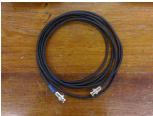
รูปที่3.26 สายนำสัญญาณพร้อมหัวต่อ BNC 50 ohm
