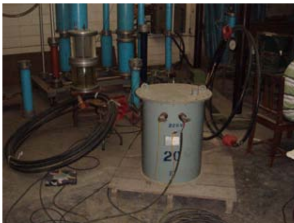
รูปที่ 4.22 ภาพวงจรตรวจวัดค่าตัวประกอบกำลังสูญเสียเปล้าไดอิเล็กทริกแบบเปรียบเทียบ
