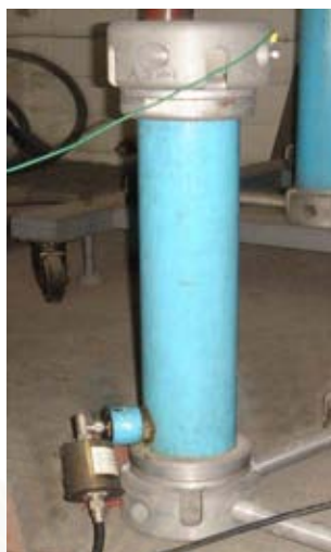
รูปที่3.23 C divider ratio =1000
