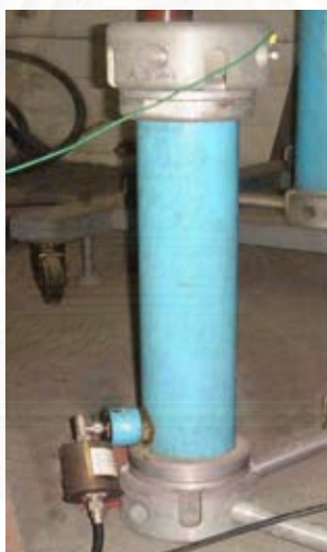
รูปที่ 4.15 ตัวดีไวเดอร์แรงดันแบบตัวเก็บประจุ
