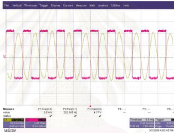
รูปที่ ก.4 แสดงสัญญาณอินพุตขนาด 100 mV และเอาต์พุตเมื่อมีแกนเวลาเป็น 5 ms/Div
