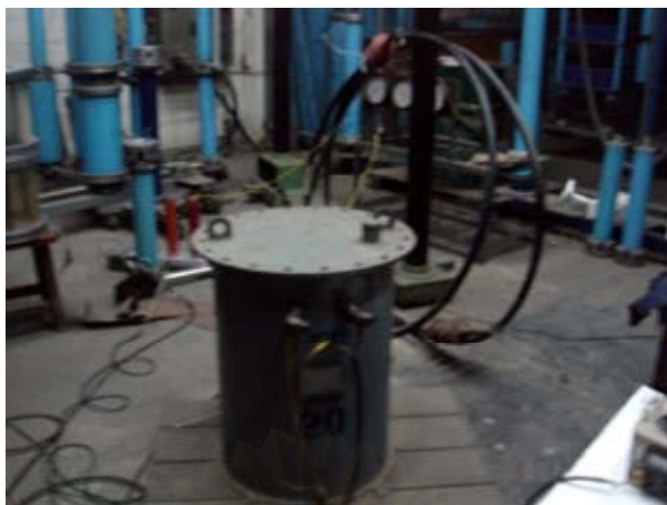
รูปที่ 4.18 ภาพวงจรตรวจวัดค่าตัวประกอบกำลังสัญญาณไดอิเล็กทริก
