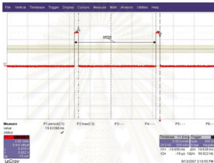
รูปที่ 4.7 แสดงสัญญาณพัลส์ที่ใช้ตรวจสอบชุดไทเมอร์
