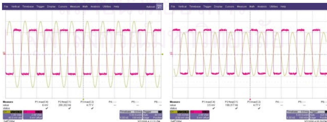
รูปที่ 4.12 แสดงสัญญาณรูปคลื่นอินพุตกับเอาต์พุตเมื่ออินพุตมีขนาด 50 mV และ 100mV
