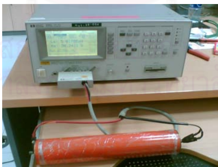
รูปที่ 3.14 การวัดค่าความเหนียวนำและค่าความต้านทานของตัวต้านอิมพัลส์ จากค่าความต้านทานและความเหนียวนำที่ได้เมื่อนำมาพิจารณา
