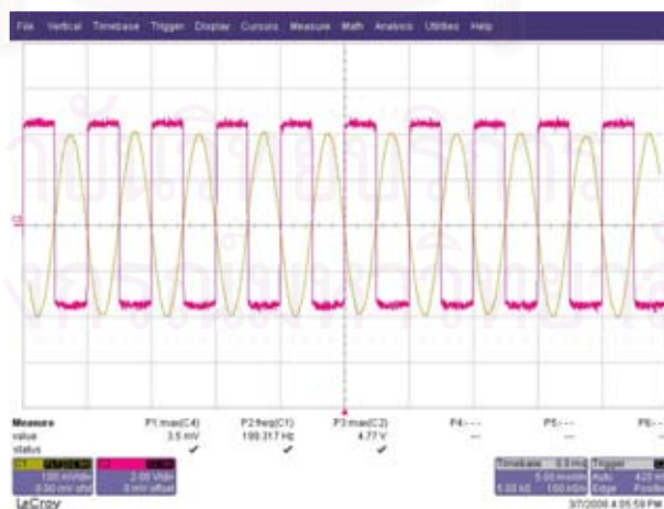
รูปที่ ก.5 แสดงสัญญาณอินพุตขนาด 200 mV และเอาต์พุตเมื่อมีแกนเวลาเป็น 5 ms/Div
