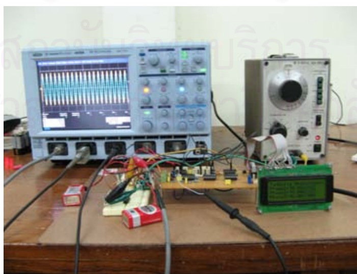
รูปที่ 4.8 แสดงการทดสอบและปรับเทียบอุปกรณ์วัดที่พัฒนาขึ้น
