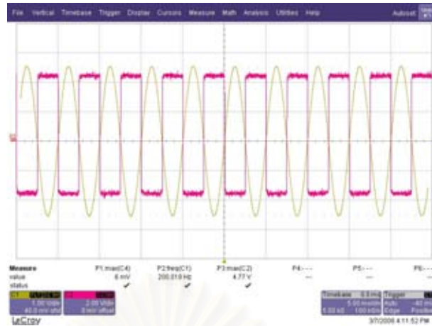
รูปที่ ก.9 แสดงสัญญาณอินพุตขนาด 2.5 V และเอาต์พุตเมื่อมีแกนเวลาเป็น 5 ms/Div
