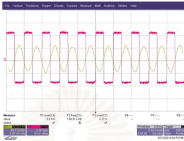
รูปที่ ก.3 แสดงสัญญาณอินพุตขนาด 50 mV และเอาต์พุตเมื่อมีแกนเวลาเป็น 5 ms/Div
