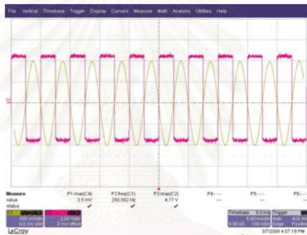
รูปที่ ก.7 แสดงสัญญาณอินพุตขนาด 1 V และเอาต์พุตเมื่อมีแกนเวลาเป็น 5 ms/Div
