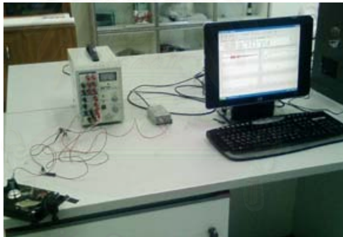
(ก) รูปแสดงการวัดสัญญาณ AE โดยเครื่องมือ PCI-2
