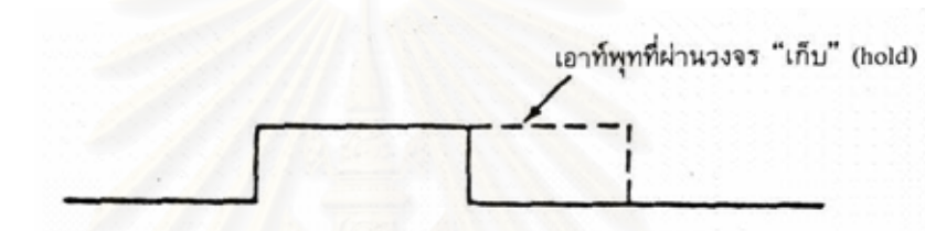
(ค) เอ้าท์พุทจากอุปกรณ์จากอุปกรณ์แปลงสัญญาณ
