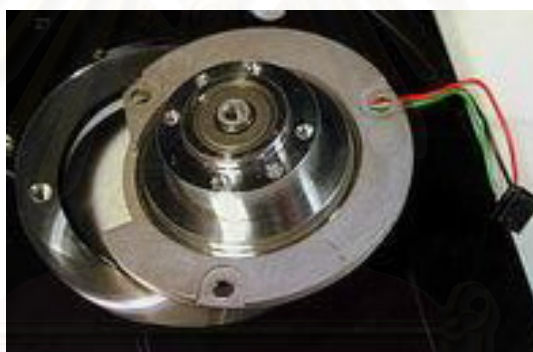
รูปที่ 3.4 รูปสปินเดิลมอเตอร์ในฮาร์ดดิสก์
