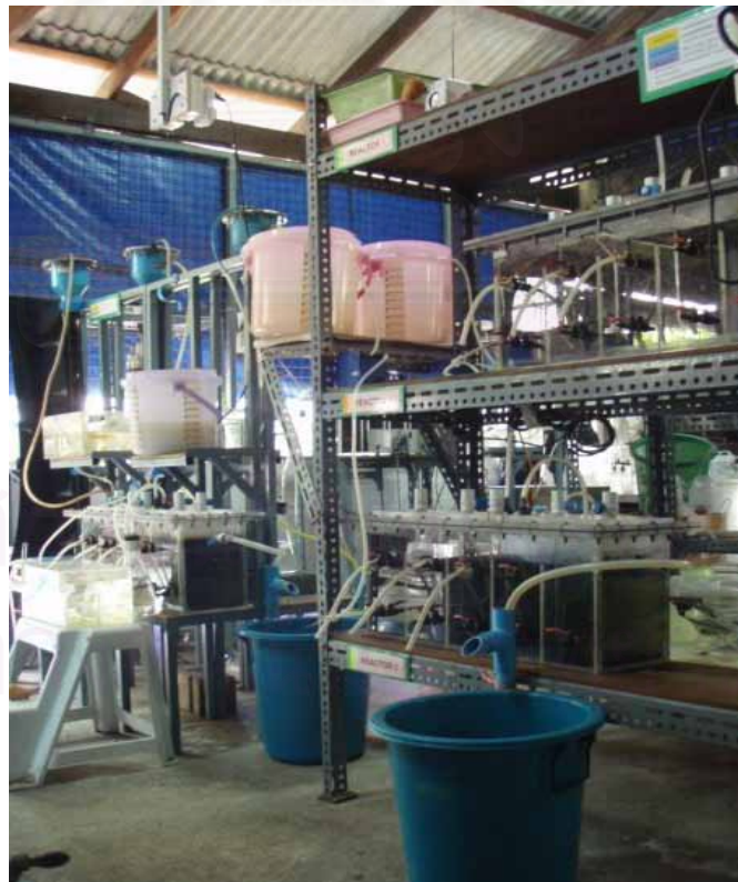
รูปที่ 3.2 ชุดระบบแผ่นกั้นไร้ออกซิเจนที่ใช้ในการทดลอง
