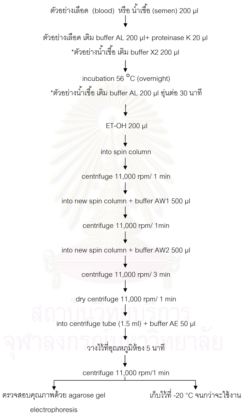
ภาพที่ 3.1 ขั้นตอนการสกัดดีเอ็นเอจากเลือด และน้ำเชื้อสุกร โดยชุดน้ำยาสกัดแยกดีเอ็นเอสำเร็จรูป (QIAamp ® DNA Blood Mini kit)
