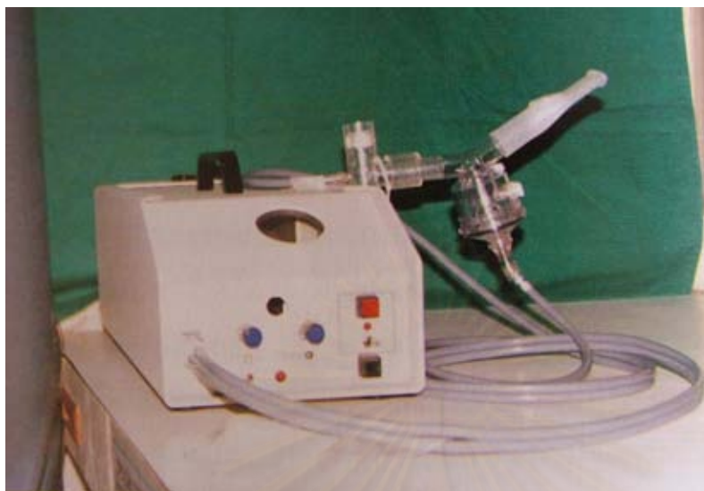
ภาพที่ 3 เครื่อง Rosenthal dosimeter และ Devilbiss nebulizer
