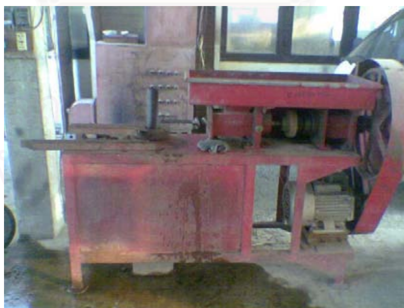
รูปที่ 3.8 เครื่องอัดแท่งเชื้อเพลิง
