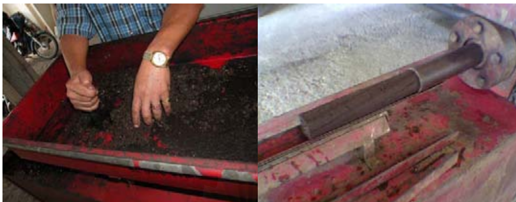
รูปที่ 3.9 การอัดขยะเป็นแท่งเชื้อเพลิง
