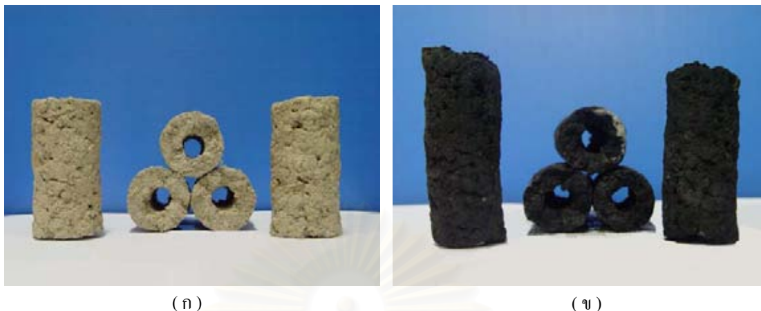
รูปที่ 4.7 แท่งเชื้อเพลิงอัตราส่วนเศษกระดาษต่อเศษไม้และใบไม้ 100:0 % โดยน้ำหนัก (ก) เชื้อเพลิงแห้ง, (ข) ถ่านเชื้อเพลิง
