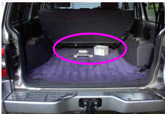
รูปที่ ก-5 การติดตั้ง Bump Integrator
