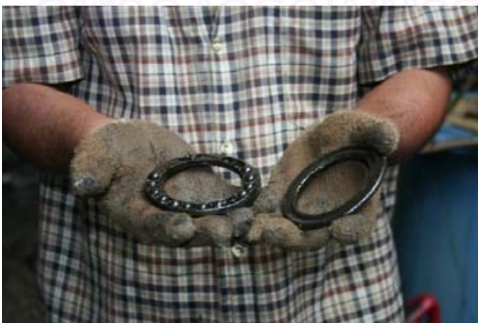
รูปที่ ข-51 แสดงวงแหวนและลูกปืนที่ใช้ในแม่แรงเหล็ก ทำให้ผ่อนแรงในการหมุน
