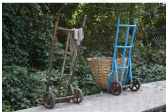
รูปที่ 6-73 แสดง ทางสัญจรในหมู่บ้านสาขลา มีความกว้างประมาณ 1.2-1.5 ม. จึงต้องใช้รถเข็น 2 ล้อ บรรทุกสิ่งของในหมู่บ้านสาขลา น้ำหนักในการบรรทุกแต่ละครั้งไม่เกิน 250 กิโลกรัม เพราะเป็นน้ำหนักที่แรงงานหนึ่งคนจะเข็นได้
