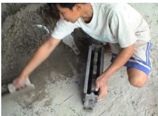
รูปที่ 6-83 แสดงตัวอย่างแรงงานผลิตบล็อกคอนกรีตมีส่วนผสมของหินปูน ซีเมนต์ และน้ำ เป็นโดยใช้เทคโนโลยีระดับกลาง ถ่ายจากเมืองหลวงพระบาง
