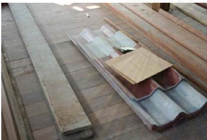
รูปที่ 6-48 แสดงวัสดุก่อสร้างที่ใช้ในการก่อสร้างด้วยเทคนิคการก่อสร้างระดับกลาง เช่น ไม้แปรรูป กระเบื้องลอนคู่ ไม้อัด วัสดุเหล่านี้ใช้เทคโนโลยีระดับกลางในการผลิต
