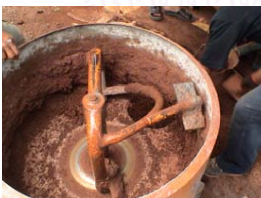
รูปที่ 6-85 แสดง เครื่องกวนส่วนผสมระหว่างดินลูกรัง ซีเมนต์ และน้ำ ใช้ผลิตดินซีเมนต์บล็อก ใน อ.ลำตะคอง จ. นครราชสีมา
