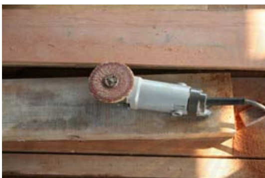
รูปที่ 6-45 แสดงเครื่องมือสำหรับตัดผิวไม้ เป็นเครื่องจักรไฟฟ้าที่ต้องอาศัยความชำนาญในการใช้งานเพื่อหลีกเลี่ยงอุบัติเหตุและความเสียหายต่อชิ้นงาน
