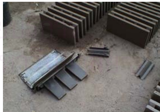
รูปที่ 6-82 แสดงแบบเหล็กสำหรับหล่อก้อนบล็อคอนกรีต ใช้แรงงานคนเป็นผู้ผสมหินปูน ซีเมนต์ และน้ำและอัดเข้าไปในแบบหล่อ จัดเป็นวัสดุที่ผลิตด้วยเทคโนโลยีระดับกลาง
