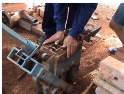
รูปที่ 6-86 แสดง เครื่องอัดก้อนบล็อก ใช้แรงงานคนในการบรรจุดินลูกรังลงในแบบเหล็ก ใช้กลศาสตร์ทดแรงในการใช้คานงัดคานดีดอัดดินให้ได้รูป
