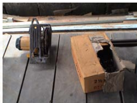
รูปที่ 6-46 แสดงเลื่อยไฟฟ้า ใช้ตัดไม้ที่มีความหนามาก เช่น ไม้อัดยาง ใช้ทุ่นแรงในการตัดไม้ให้ได้ตามรูปทรงตามที่ต้องการ
