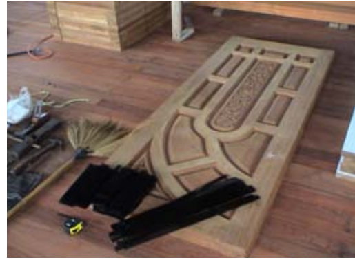
รูปที่ 6-78 แสดงประตูไม้สัก ลูกฝักไม้สักแกะสลัก โดยใช้ไม้ที่ผ่านการถนอมรักษาโดยการอบ เป็นวัสดุที่ผลิตจากเทคโนโลยีการผลิตระดับกลาง โดยมีโรงงานไม้แปรรูปอยู่นอกหมู่บ้านสาขลา
