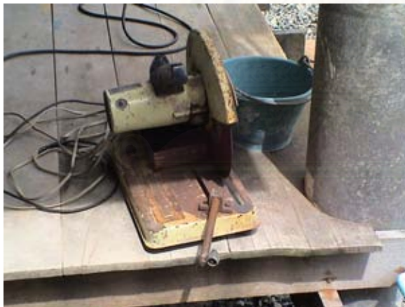
รูปที่ ข-4 แสดงเลื่อยไฟฟ้าสำหรับตัดเหล็กรูปพรรณและเหล็กเส้น ใช้ในการก่อสร้างอาคารพักอาศัย 3 ชั้นที่ก่อสร้างโดยผู้รับเหมาพิชิต จักรพงษ์สุวรรณ
