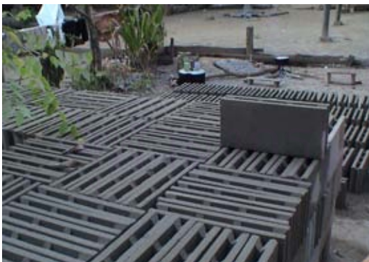
รูปที่ 6-81 แสดงบล็อกคอนกรีต ใช้สำหรับก่อผนังอาคาร มีส่วนผสมของหินปูน ซีเมนต์ และน้ำ โดยมีซีเมนต์เป็นตัวประสานหินปูนเข้าด้วยกัน เป็นวัสดุก่อสร้างที่ต้องจัดหามาจากนอกหมู่บ้านสาขลา
