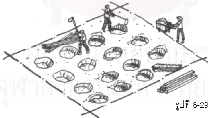
รูปที่ 6-28 แสดง ขั้นตอนที่ 3 บักฝัง โดยใช้ท่อนไม้ที่มีความยาวตามที่ ต้องการเป็นเครื่องมือวัด
