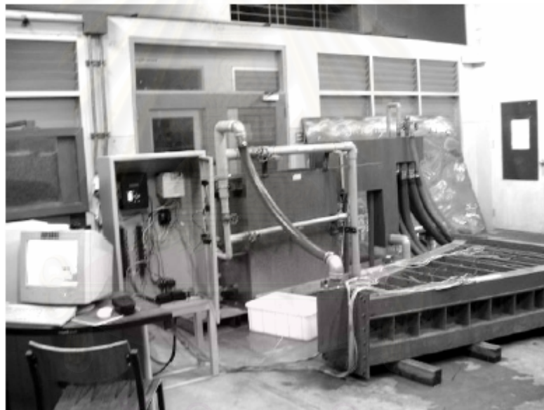
รูปที่ ง-12 ภาพถ่ายขณะทำการทดลองการไหลในแนวนอน
