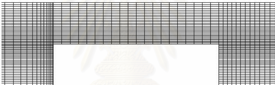
รูปที่ 5.14 การขยายกริดที่ละเอียดบริเวณรอบรูปสี่เหลี่ยมผืนผ้า ของการจำลองการไหลผ่านรูปสี่เหลี่ยมผืนผ้าที่ค่า Re_H = 144 (Not to scale)
