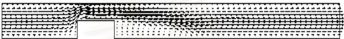
รูปที่ 5.15 เวกเตอร์ความเร็วการจำลองการไหลผ่านรูปทรงสี่เหลี่ยมผืนผ้าที่ค่า Re_H = 144 (Not to scale)
