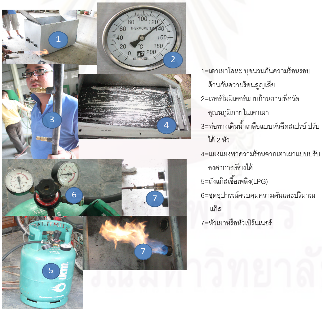
รูปที่ 3.2 เครื่องเร่งการระเหยของน้ำเกลือโดยวิธีการพาความร้อนแยกชิ้นส่วน 1 ถึง 7
