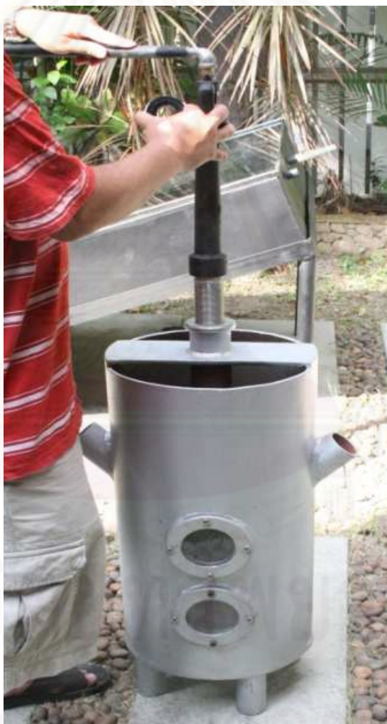
รูปที่ 3.5 ชุดอุปกรณ์เครื่องเร่งการระเหยของน้ำเกลือโดยวิธีแบบจุ่มสันดาป
