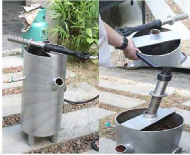
รูปที่ 3.17 แสดงการตรวจสอบความเรียบร้อยของหัวเผาและสายส่งแก๊ส
