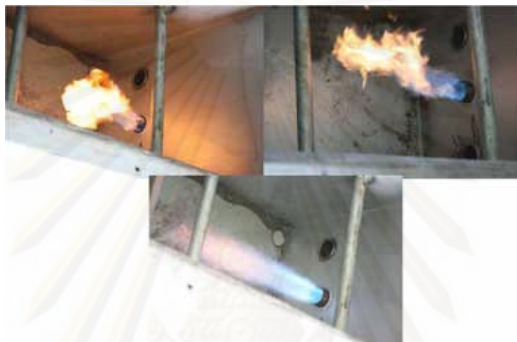
รูปที่ 3.12 แสดงการปรับระบบไหลเวียนของอากาศภายในเตาเผาและปรับเปลวไฟให้ได้ความร้อน
