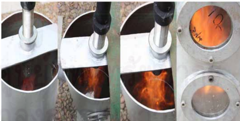
รูปที่ 3.18 แสดงการตรวจสอบระบบอากาศไหลเข้าและไหลออกภายในเตาเผา(สีเปลวไฟ)
