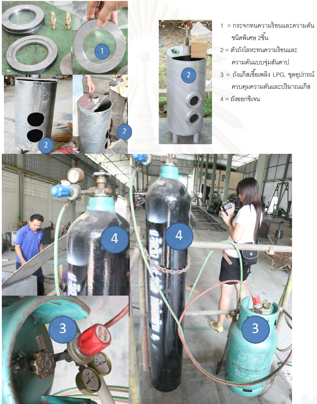
รูปที่ 3.6 เครื่องเร่งการระเหยของน้ำเกลือโดยวิธีแบบจุ่มสันดาปแยกชิ้นส่วน 1 ถึง 4
