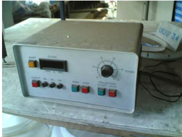
ภาพที่ 3.19 แสดงอุปกรณ์ควบคุมการเปิดปิดน้ำและจับเวลาการไหลของน้ำ
