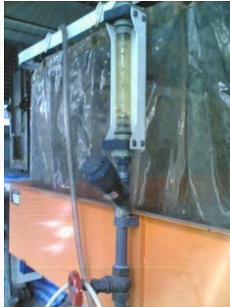
ภาพที่ 3.20 แสดงอุปกรณ์ควบคุมความดันและปริมาณน้ำให้ได้ตามต้องการ
