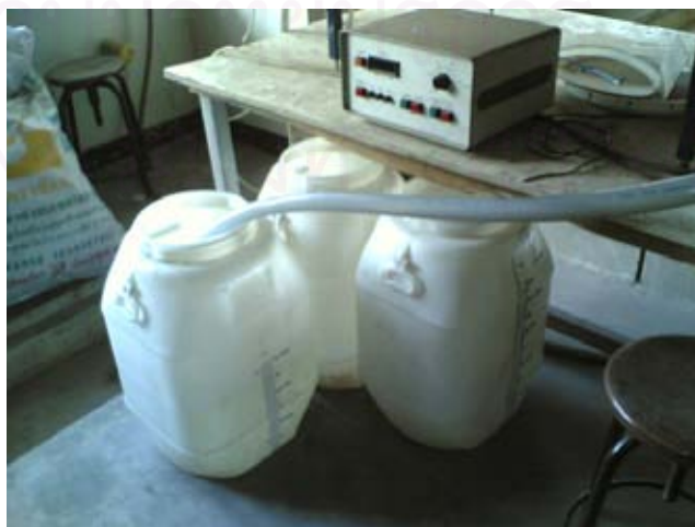
ภาพที่ 3.21 แสดงถังน้ำที่ทำมาตราส่วนเพื่อเก็บข้อมูลปริมาณการไหลของน้ำ
