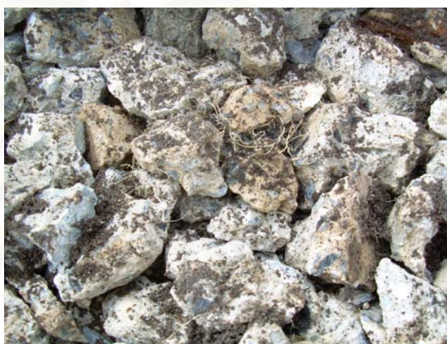
ภาพที่ 3.3 เศษปูนขนาด 2 ถึง 4 นิ้วโดยประมาณ
