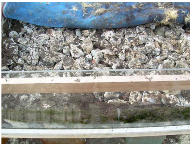
ภาพที่ 3.11 แสดงการตัวอย่างการบรรจุวัสดุชะลอน้ำลงในกระบะทดลอง
