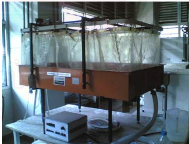
ภาพที่ 3.18 แสดงอุปกรณ์จำลองน้ำฝนในห้องปฏิบัติการชลศาสตร์ (Rainfall Hydrograph)
