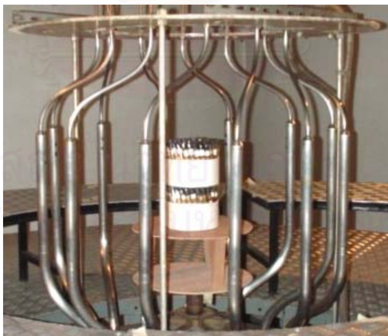
รูปที่ 3.8 เครื่องฉายรังสีแกมมาจากแหล่งกำเนิดรังสีโคบอลต์ - 60
