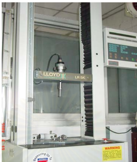
รูปที่ 3.11 เครื่อง Universal Testing Machines สามารถหาค่าความทนทานต่อแรงดึง ของบริษัท LLOYD INSTRUMENTS Ltd., รุ่น LLOYD LRK
