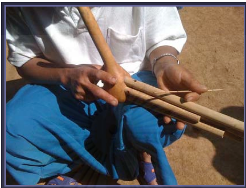
ภาพที่ 54 ช่างทำฟiddle เลือกขนาดของลิ่มเพื่อให้มีความเหมาะสม
