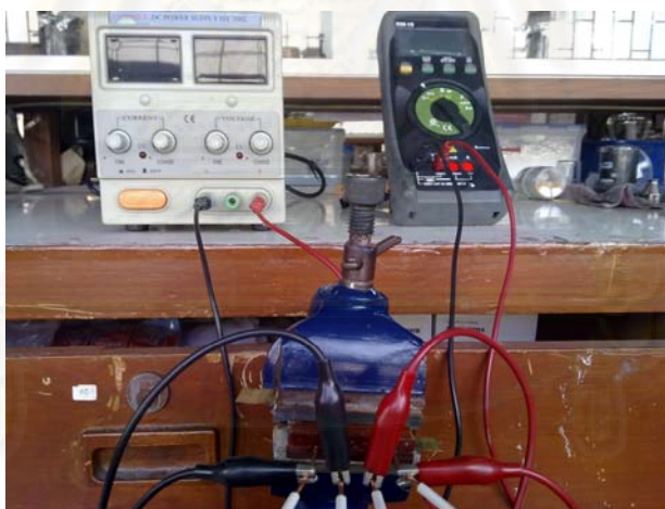
รูปที่ 3.4 การวัดค่าการนำไฟฟ้าด้วยเทคนิค four point probe
