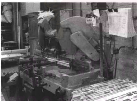
ขั้นตอนที่ 1 การตัดเส้น UPVC เพื่อทำวงกบและกรอบบาน
