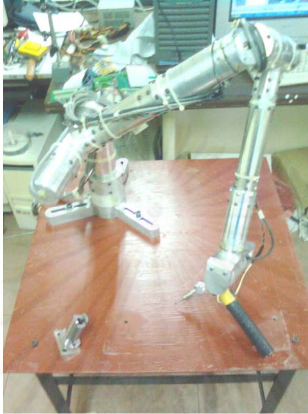
รูปที่ 4.7 เครื่องวัดพิกัด 3 มิติ ซียู-ซีเอ็มเอ็ม ที่ได้มีการดัดแปลงแล้ว
