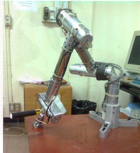
รูปที่ 6.1 ขณะก็นำปลายหัววัดสวมเข้ากับแท่นอ้างอิง
