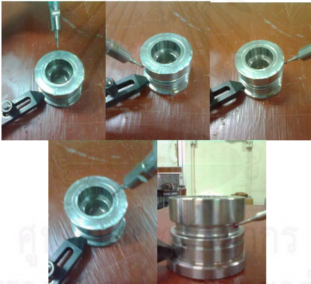
รูปที่ 7.17 การทดลองทำการกัดทรงกระบอก
