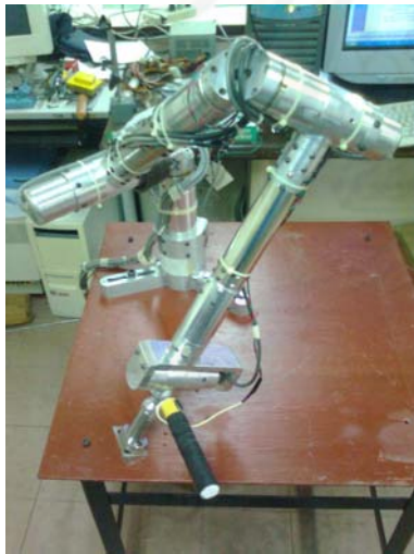
รูปที่ 6.1 ขณะก็นำปลายหัววัดสวมเข้ากับแท่นอ้างอิง
