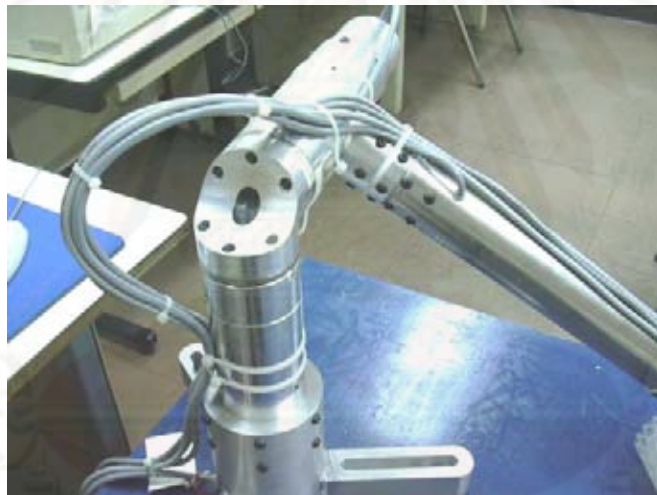
รูปที่ 3.1 บริเวณข้อต่อที่ 2 ของเครื่องวัดพิกัด 3 มิติซียู-ซีเอ็มเอ็ม [2]
