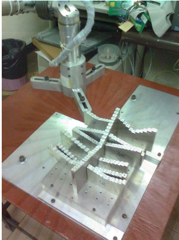
รูปที่ 7.4 ชิ้นงานสอบเทียบบนฐานของเครื่องซียู-ซีเอ็มเอ็ม
