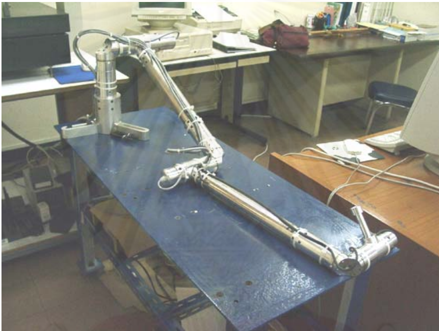
รูปที่ 2.1 เครื่องวัดพิกัด 3 มิติซียู-ซีเอ็มเอ็ม [2]
