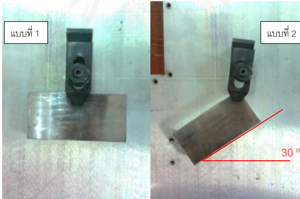
รูปที่ 7.9 รูปแบบการจับยึด 2 รูปแบบของชิ้นงานขนาดเล็ก
