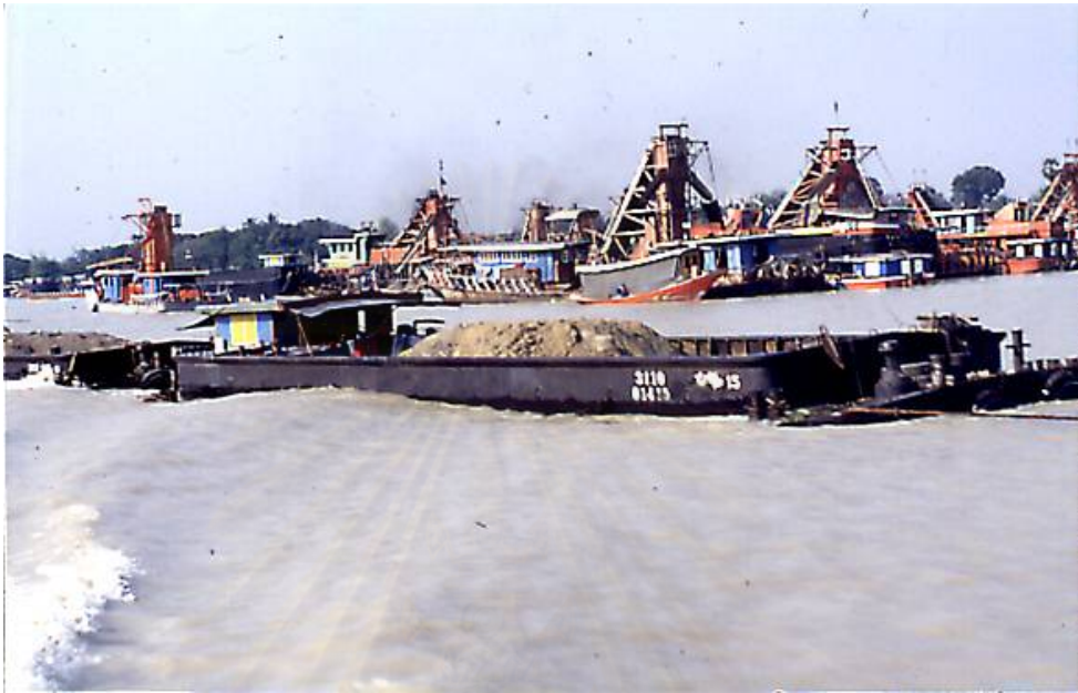
รูปที่ 3.2 การขนส่งทรายด้วยเรือลำเลียงที่ขุดกลางแม่น้ำเจ้าพระยา
