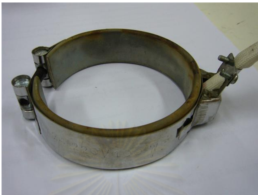
รูปที่ ข-23 ขดลวดความร้อนขนาด 100 W
