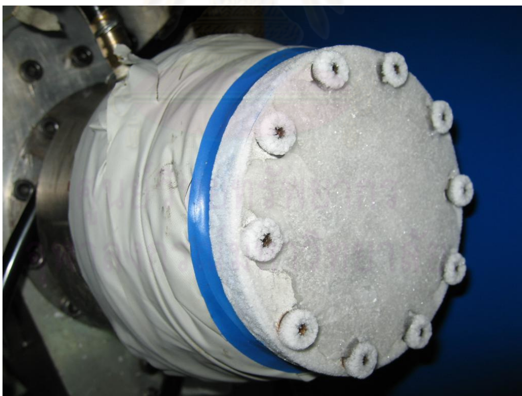
รูปที่ ข-6 เครื่องทำความเย็นสเตอร์ลิงหลังทำความเย็น 20 นาที
