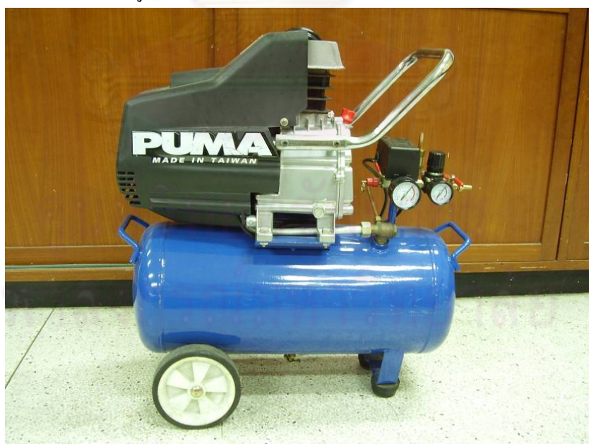
รูปที่ ข-24 ถังลมพร้อมกับอุปกรณ์ควบคุมแรงดันยี่ห้อ PUMA
