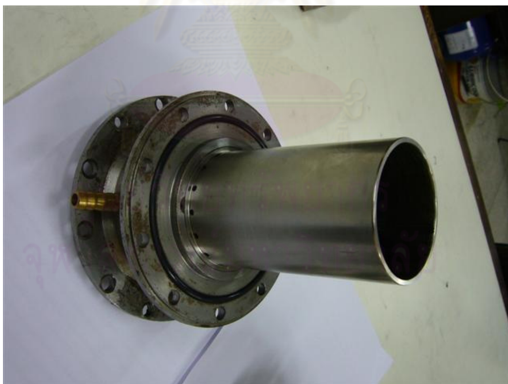
รูปที่ ข-12 ฐานกระบอกสูบและปลอกลูกสูบ
