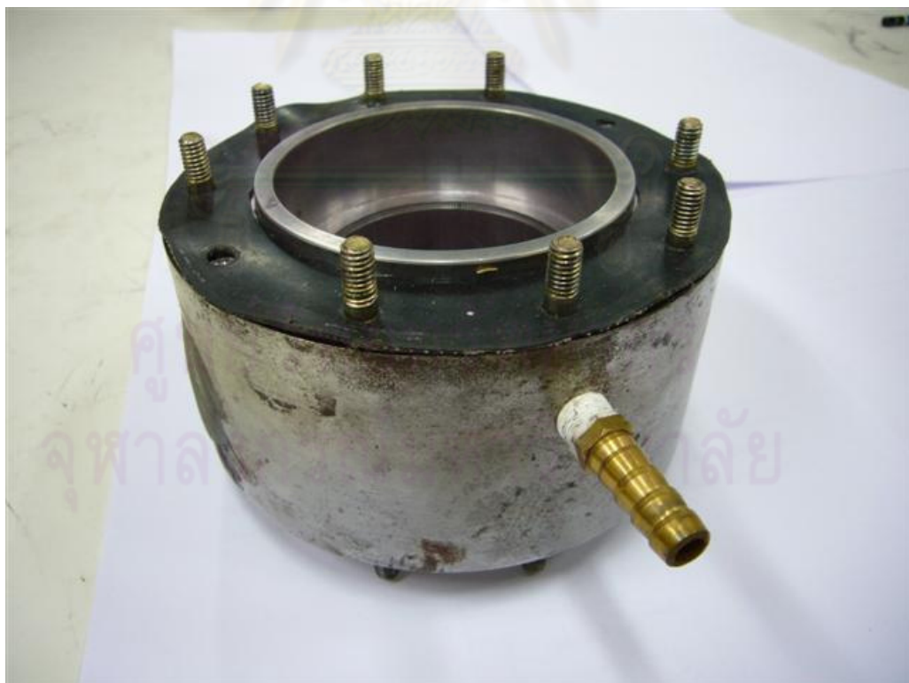
รูปที่ ข-10 ปลายด้านร้อนหุ้มด้วยเสื้อน้ำ
