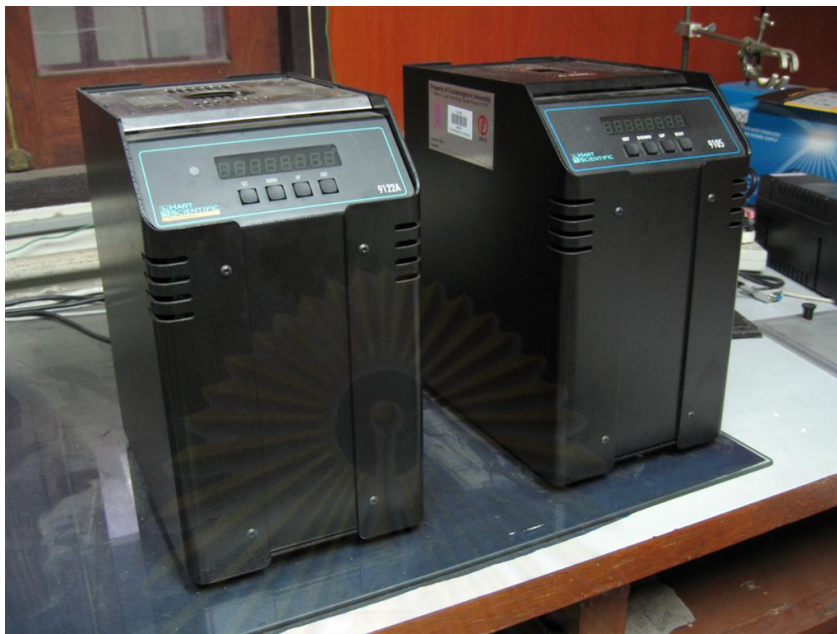
รูปที่ ข-19 เครื่องสอบเทียบอุณหภูมิ Hart Scientific 7103
