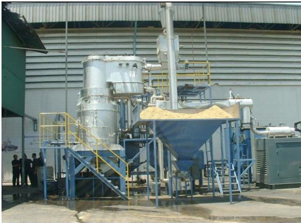
รูปที่ 4.23 เตาผลิตแก๊สแบบสามชั้นตอนของกรมพัฒนาพลังงานทดแทนและอนุรักษ์พลังงาน ม.เกษตร และ บจ.เกรท อะโกร (ที่มา บริษัท เกรท อะโกร จำกัด : ออนไลน์)
