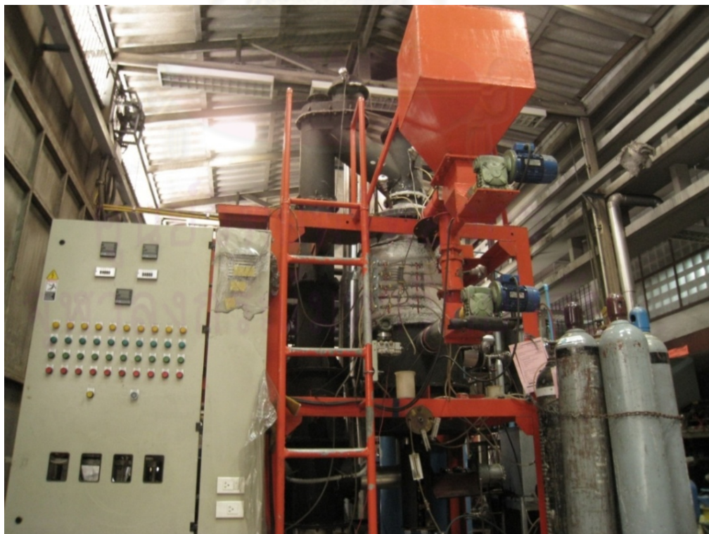
รูปที่ 4.8 เตาผลิตแก๊สแบบเบดคู่ที่สร้างเสร็จอย่างสมบูรณ์
