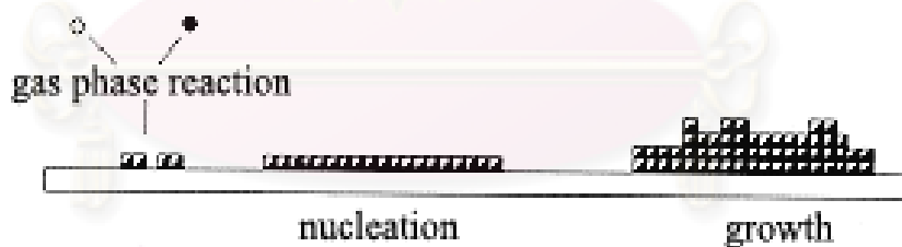
รูปที่ 2-16 ขั้นตอนการเกิดซิลิคอนคาร์ไบด์แบบแท่งเข็มโดยวิธี vapor-solid reaction [16]
