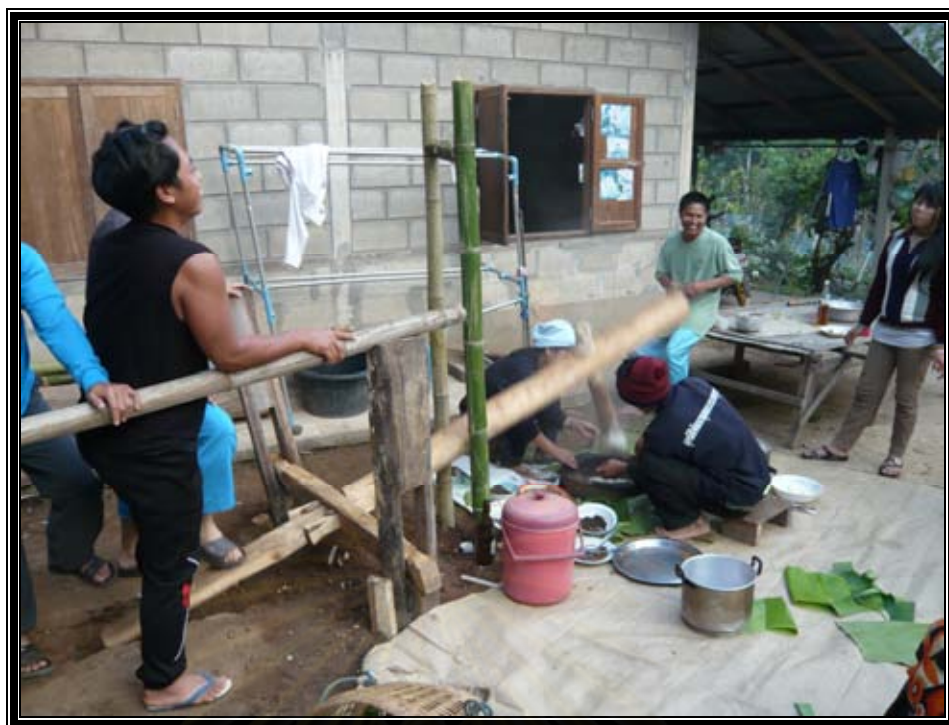
ภาพที่ ๓.๓๒ การตำขนมข้าวปุกโดยใช้แรงงานช่วยกันเหยียบครกกระเดื่อง
