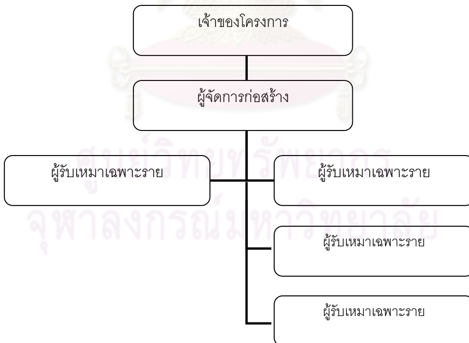
แผนผังที่ 2.5 รูปแบบการว่าจ้างทีมงานผู้จัดการงานก่อสร้าง
