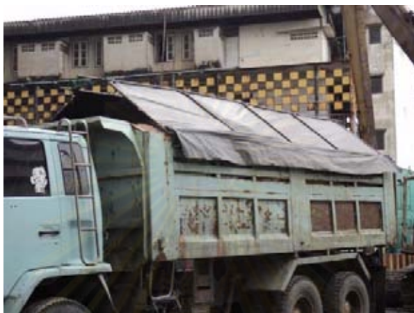
รูปที่ 4.7 แสดงการใช้ผ้าใบคลุมรถขนส่งโครงการที่ 1
