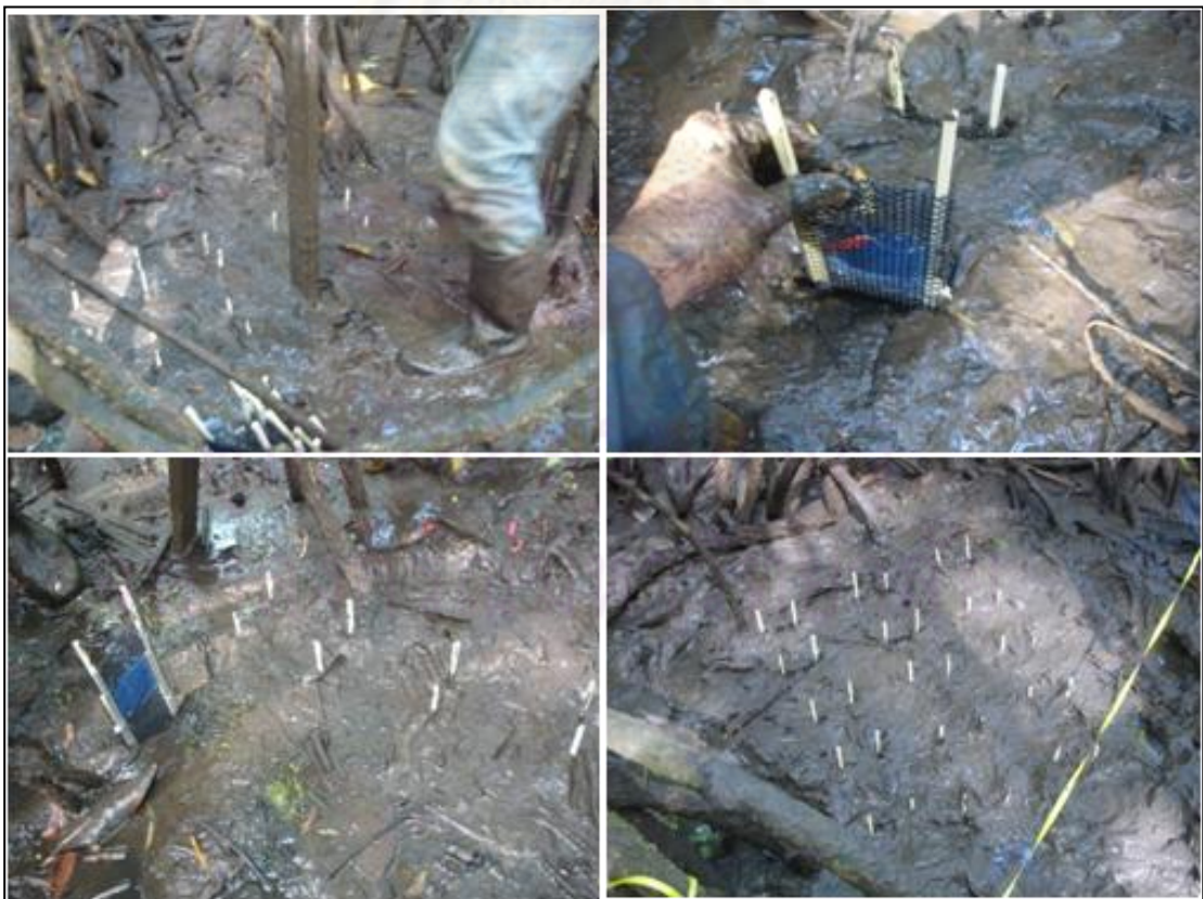
ภาพที่ 3.10 การฝังแผ่นตาข่ายพลาสติกที่มีถุงตาข่ายไนลอนที่บรรจุซากจากฝอยในแปลงย่อยที่กำหนดไว้
