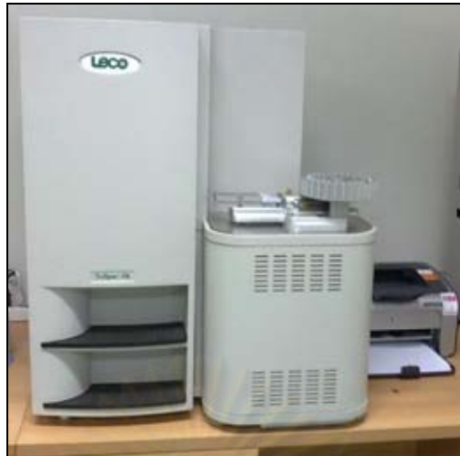
ภาพที่ 3.11 เครื่อง CN Analyzer เพื่อวิเคราะห์ปริมาณคาร์บอนและไนโตรเจนในซากจากฝอย
