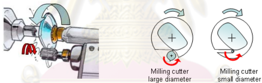
รูปที่ 3.23 การตัดเลนส์แบบละเอียด
