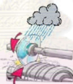
รูปที่ 3.26 การตัดเลนส์แบบ Organic
