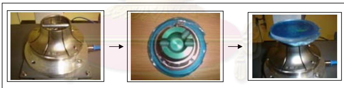
รูปที่ 4.7 ขั้นตอนการวางเลนส์บนเครื่อง Trinocular
