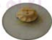
รูปที่ 3.19 เลนส์ที่ผ่านกระบวนการบดล็อกเลนส์
