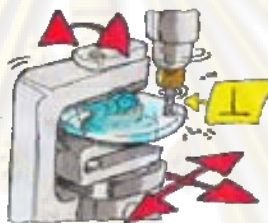
รูปที่ 3.34 การกำหนดจุดบนเลนส์ก่อนการเจาะเลนส์
