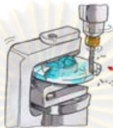
รูปที่ 3.25 การเซาะร่องเลนส์
