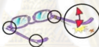
รูปที่ 3.64 ลักษณะการตรวจสอบ 4 จุดสัมผัสของเฟรม
