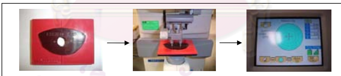
รูปที่ 4.5 กระบวนการวัด Axis ของเครื่อง Focimeter
