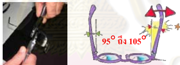
รูปที่ 3.61 ลักษณะการตรวจสอบมุมการกางออกของขาแว่น
