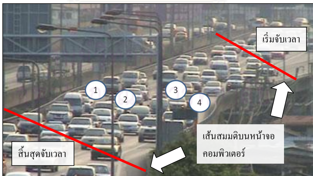
ภาพที่ 3.15 การหาความเร็วในการเคลื่อนที่ของรถ
