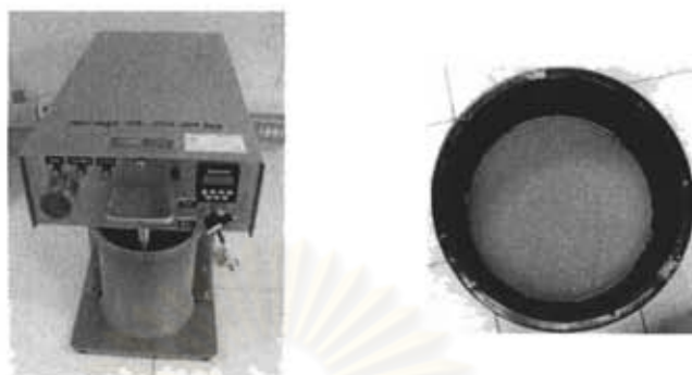
ภาพที่ 3-9 เครื่องตีกระจายเยื่อและลักษณะน้ำเยื่อที่ได้หลังจากตีกระจายเยื่อเรียบร้อยแล้ว
